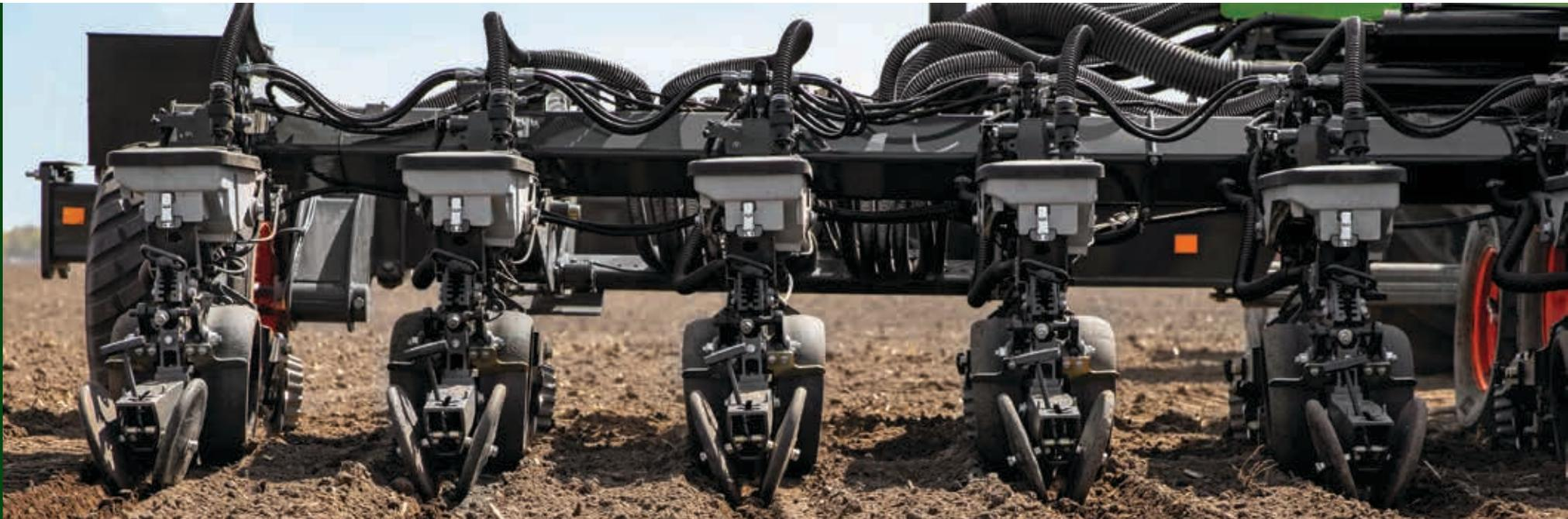
Gérez chaque unité de semis individuellement, en temps réel, pour accroître la précision. Le semoir Momentum de Fendt profite des plus récentes innovations de Precision Planting®. Elles y sont intégrées à l'usine. Cela se traduit par une précision de plus de 99 %, en permanence, tout en minimisant la compaction de la zone des racines.
