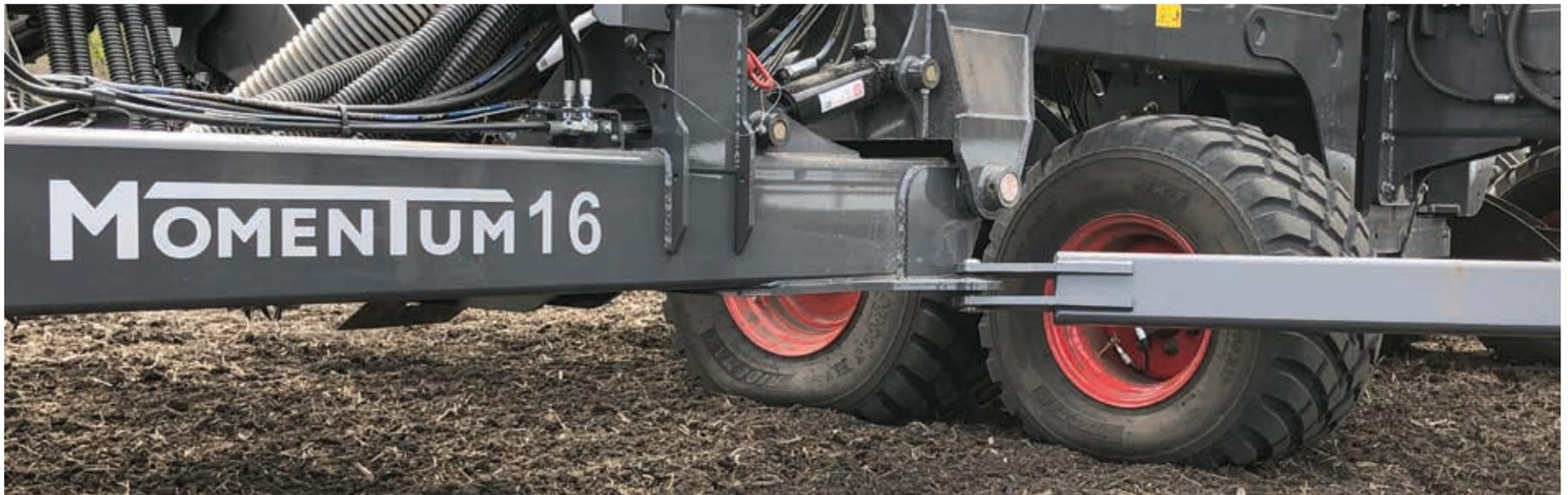
**Le système automatique de gonflage des pneus fait partie du système Load Logic de gestion de la compaction. Les fuseaux intelligents mesurent le poids porté par les pneus du Momentum et l'algorithme règle automatiquement la pression à l'optimum.**
