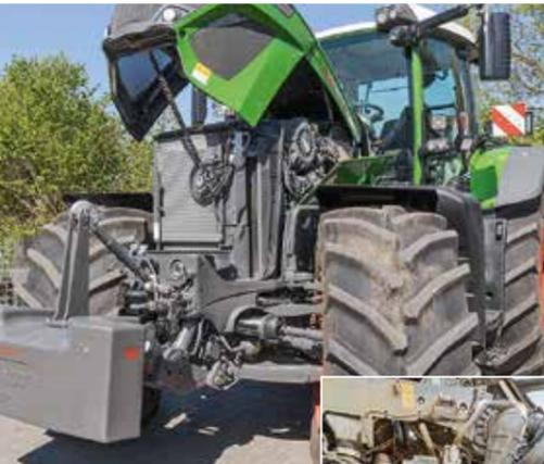
Il sei cilindri MAN, con una cilindrata di 9 l, offre un numero di giri nominale di soli 1.700 giri e un turbocompressore a geometria variabile con aste incapsulate.
