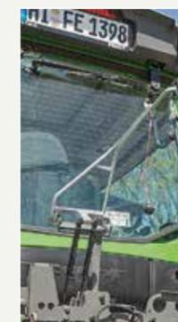
Il supporto del braccio 3° punto con ammortizzatori a pressione di gas facilita il lavoro.
