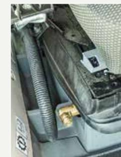
Il sedile viene alimentato dall'impianto dell'aria compressa e non dispone più di un proprio compressore. Inoltre è presente un attacco per la pulizia tramite soffiaggio della cabina.
