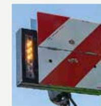
Il trattore è dotato in fabbrica di pannelli di avviso con lampeggiante integrato e di una terza luce di arresto in alto, sul tetto della cabina.
