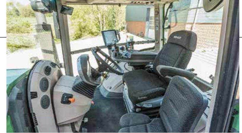
La cabine est identique à celle du 1000 Vario, mais avec une suspension à trois points.
