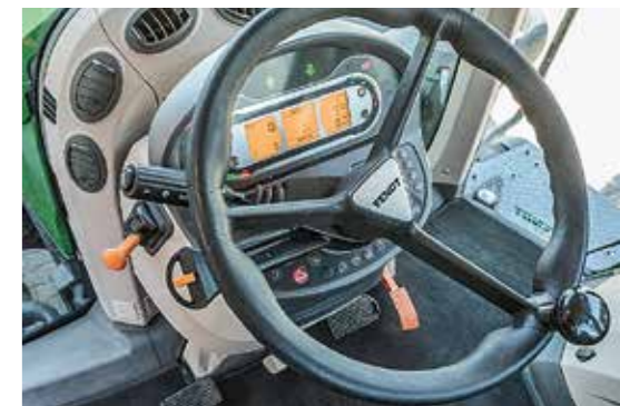
Un écran sur le tableau de bord plutôt que sur le montant A et un levier de frein à main très en avant (qui n'est quasiment jamais utilisé grâce à la transmission automatique en option).
