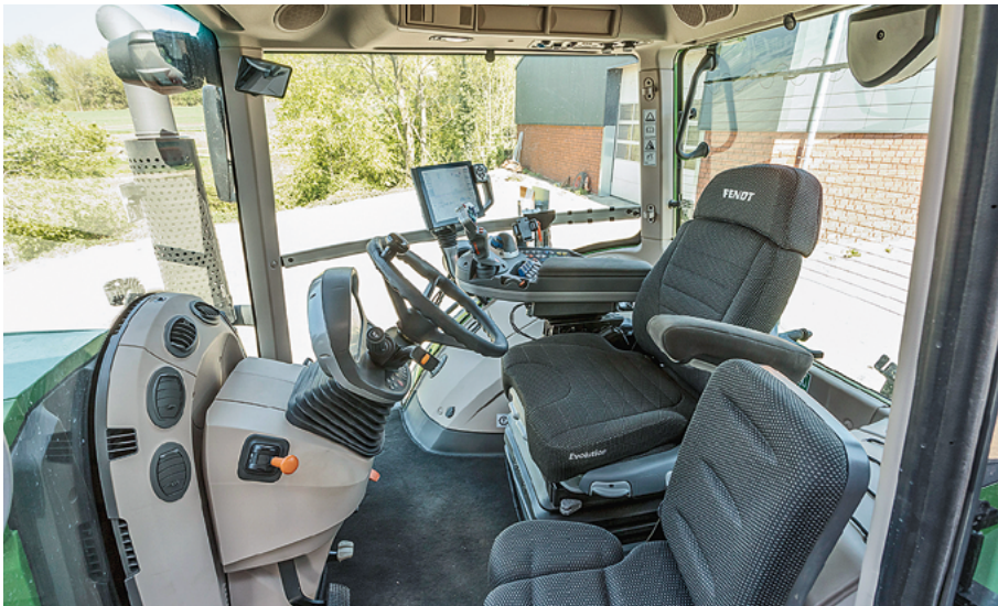
Die Kabine ist identisch mit der des 1000 Vario, hat aber eine Dreipunktfederung.
