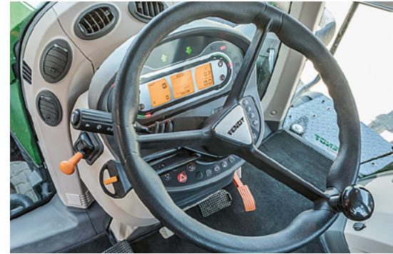
Armaturenbrett statt A-Holm-Display und Handbremshebel weit vorne (der aber dank optionaler Automatik kaum gebraucht wird).
