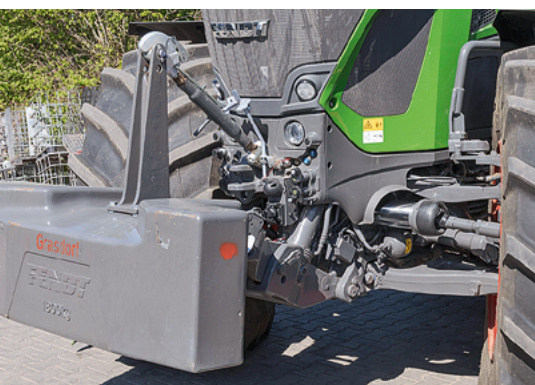
Die Vorderachse hat bis 25 km/h einen permanenten Allradantrieb.
