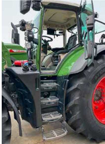
Der Aufstieg ist super, der Dieseltank mit maximal 484 l für 300 PS eher klein.
