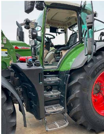
L'accesso per salire a bordo è fantastico, il serbatoio del diesel con una capacità massima di 484 l è piuttosto piccolo per un 300 CV
