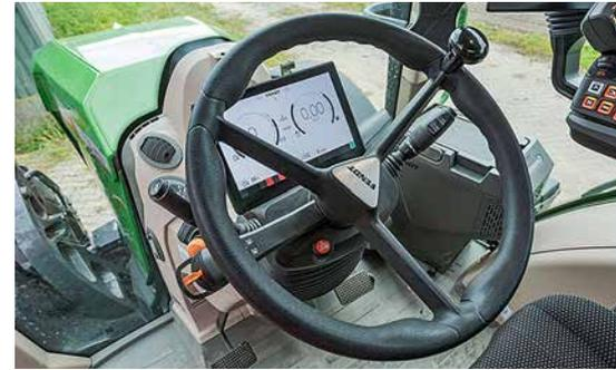
Le razze del volante interferiscono con il display meno di quanto ci si potrebbe aspettare; tuttavia riteniamo che un display installato sul montante A sarebbe una scelta migliore.
