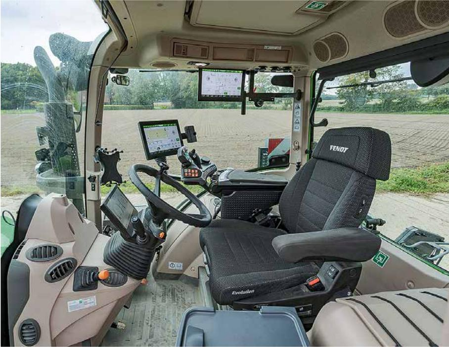
Con una misurazione di appena 69,5 dB(A) la cabina è davvero silenziosa. Anche la visibilità è buona, solo posteriormente la tendina parasole e il motore del tergicristallo possono intralciare la vista. E avere più spazio a disposizione non sarebbe male.
