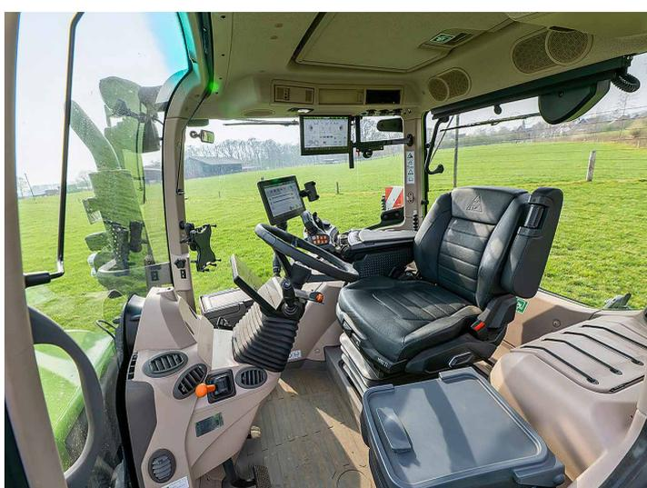
Il sedile regolabile elettricamente di Isringhausen si adatta automaticamente al conducente, se il profilo viene modificato nel terminale. Il comfort della seduta è formidabile. Da selezionare assolutamente: il blocco automatico del parcheggio. Così facendo, la leva in basso a sinistra diventa superflua.
