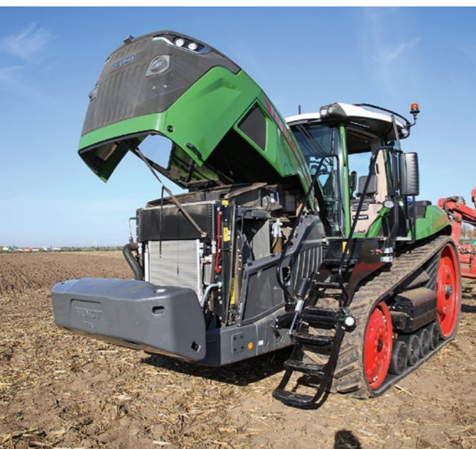
Sześciocylindrowy silnik MAN pod potężną maską jest cichy i oszczędny. Komora chłodnic jest całkowicie oddzielona od silnika.
