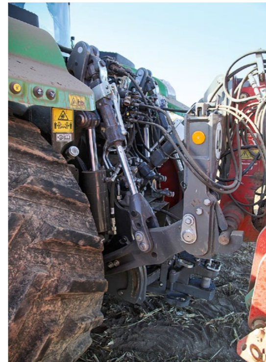
Dobrze opisane przyłącza i dźwignie redukcji ciśnienia - tak powinno być. W opcji jest maks. 8 par złączy i maksymalna wydajność hydrauliki - 440 l/min.
