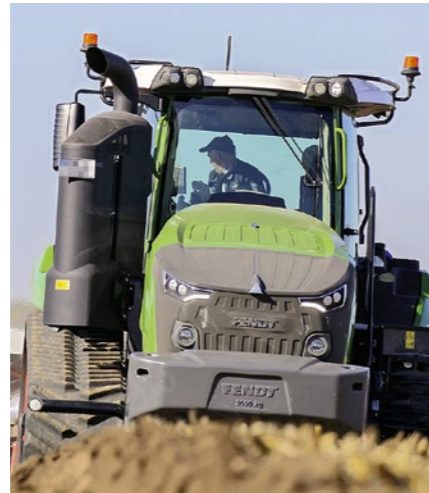
W olbrzymim zespole wydechowym jest cały układ oczyszczania spalin, tj. DOC, SCR i DPf, spełniający Euro V. Fot. Wilmer
