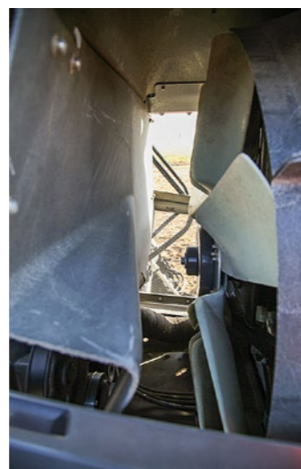
Sześciocylindrowy silnik MAN pod potężną maską jest cichy i oszczędny. Komora chłodnic jest całkowicie oddzielona od silnika.
