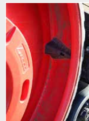
Gli espulsori mantengono i cerchi liberi da terra/residui di raccolto.
