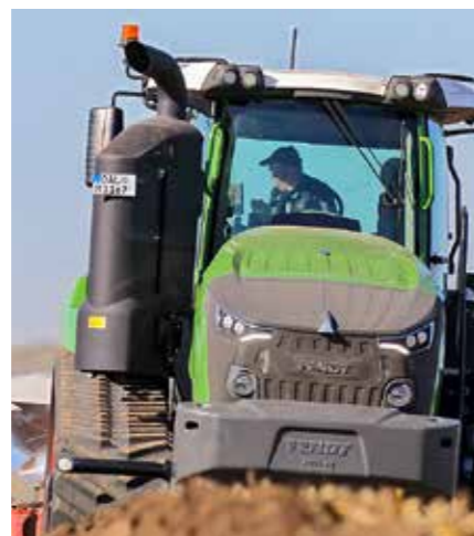
Nel gigantesco tubo di scappamento è situata tutta la tecnologia del gas di scarico, con DOC (catalizzatore di ossidazione diesel), SCR (riduzione catalitica selettiva) e DPF (filtro antiparticolato diesel) per le emissioni di livello V.
