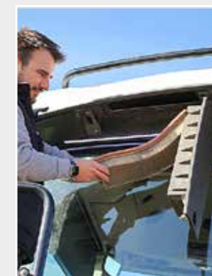
I filtri della cabina sono accessibili solo allentando tante viti.
