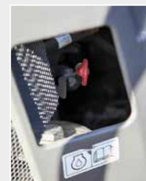
Al posto di un sensore occorre ancora estrarre un'astina di misurazione del livello dell'olio.
