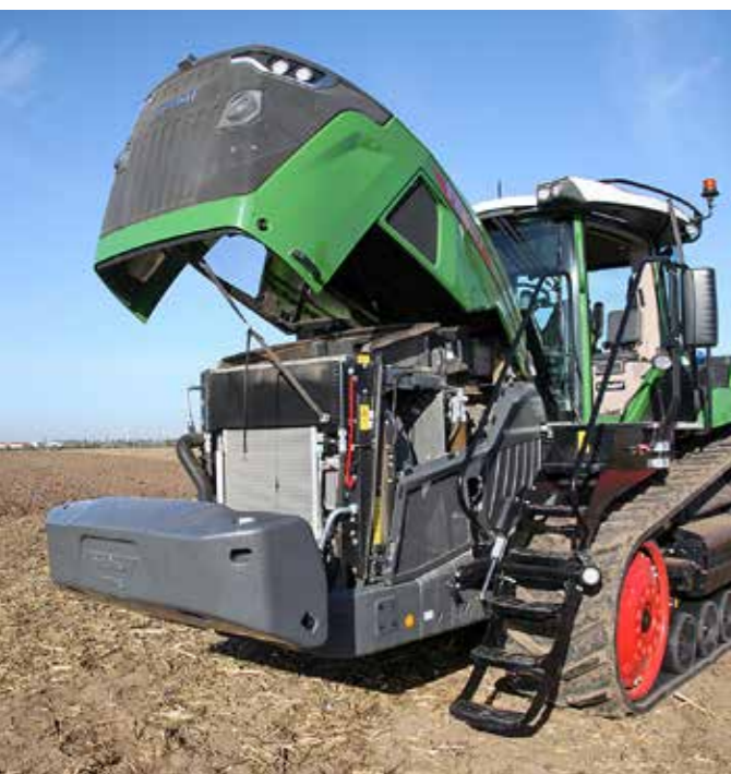
Il motore a sei cilindri MAN sotto l'imponente cofano è silenzioso e consuma poco carburante. La zona del radiatore è completamente isolata dal motore.
