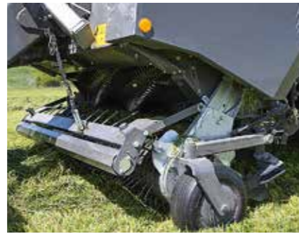
Le pickup est large de 2,20 m. Des roues de jauge latérales et un rouleau arrière assurent l'adaptation au sol. Photos : Berning
