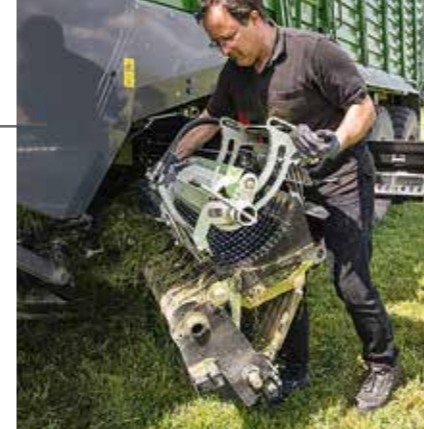
Le dispositif d'affûtage, en permanence disponible sur la remorque, est mis en place pour d'affûter dix couteaux en une seule opération.
