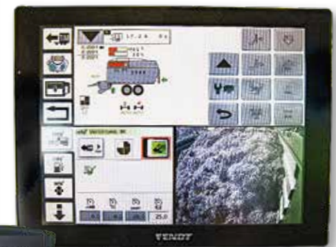
Le TIM est activé via le terminal Vario et fonctionne lorsque le régulateur de vitesse est actif.
