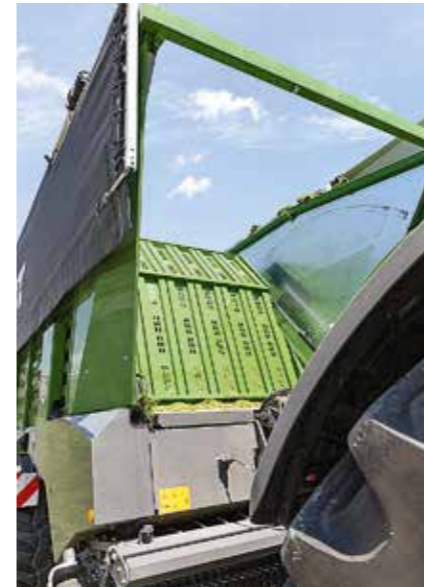
Un capteur de pression placé dans les vérins de la cloison avant rabattable commande le processus de chargement et contrôle la pré-compression.
