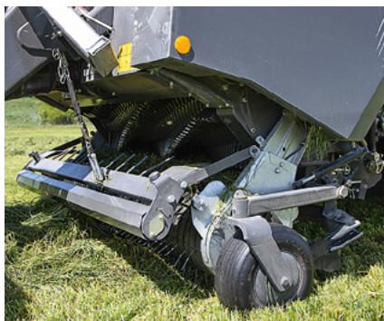
Die Pickup ist 2,20 m breit. Seitliche Tasträder und eine hintere Rolle übernehmen die Bodenadaptation. Fotos: Berning
