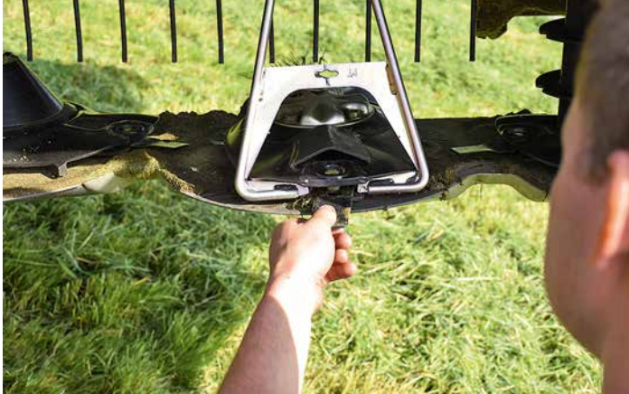
◁ Une clé de changement rapide permet de remplacer très facilement les lames.
