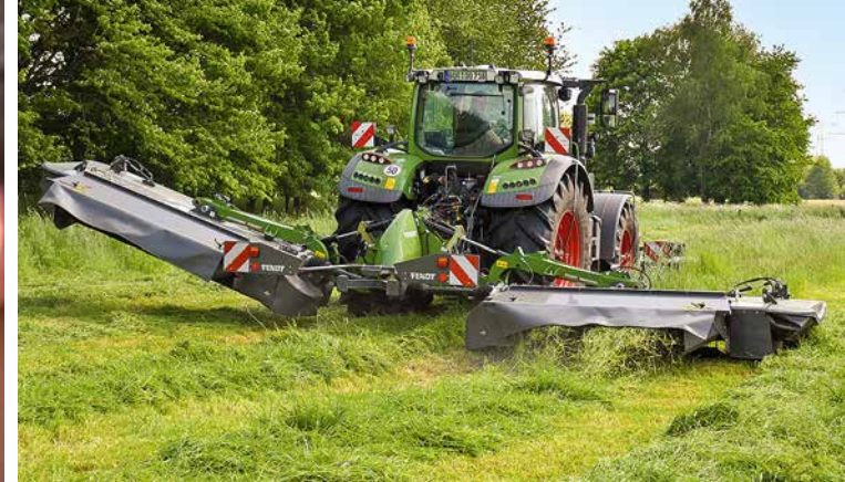
△ Les faucheuses arrière se relèvent individuellement pour faucher les pointes. Cette fonction peut être présélectionnée sur un boîtier électronique en option.
