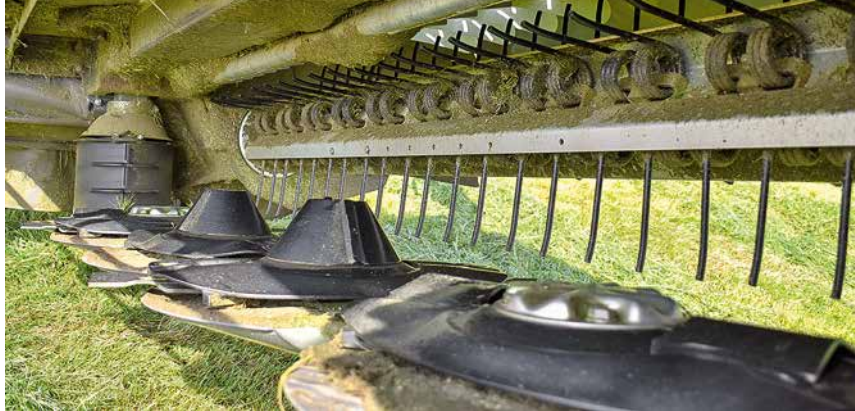
△ Les dents vibrantes du conditionneur tirent le fourrage à travers un peigne pivotant.
