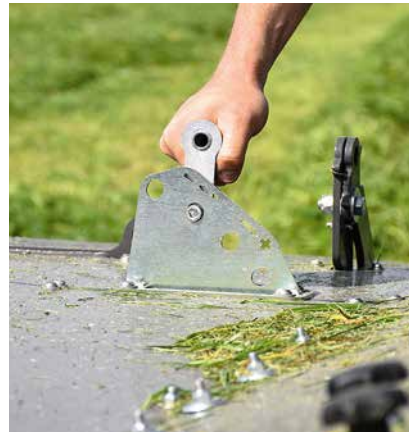
△ Chaque faucheuse dispose d'un levier permettant de régler le peigne sur quatre positions.
