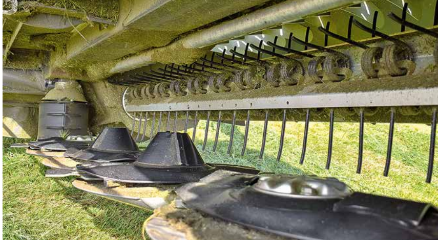
△ Die Federzinken des Aufbereiters ziehen das Futter durch einen schwenkbaren Kamm.
