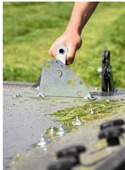
△ Über einen Hebel je Mäher lässt sich der Kamm in vier Positionen einstellen.
