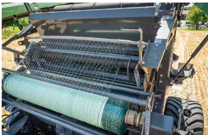
Wkładanie siatki jest proste, mechanizm wiązania działa bez zarzutu.
