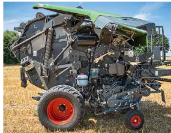
Z prawej strony znajduje się m.in. centralne smarowanie.
