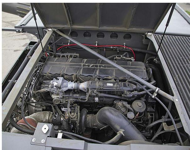
Il motore MAN eroga fino a 647 CV, il radiatore aspira solo aria dall'alto e, grazie al ventilatore con funzione di inversione, non necessita praticamente mai di essere pulito tramite soffiaggio.
