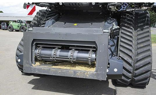
Il canale misura solo 1,40 m in larghezza, ma è dotato di quattro catene e permette di scaricare correttamente il materiale. La macchina utilizzata durante il test, purtroppo, non era dotata dell'accoppiamento automatico della testata di taglio.
