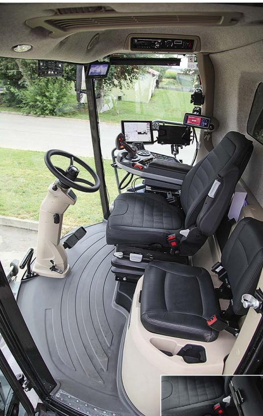
La cabina garantisce al conducente un comfort ottimale, è presente anche un vano frigo e raggiunge un livello di emissioni acustiche di max. 77 dB(A). L'impianto viva-voce, invece, non convince.
