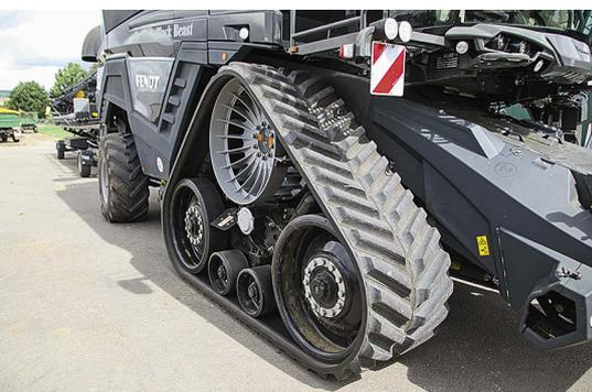
I cingoli misurano 2 m in altezza e quasi 2 m di larghezza. Con i tappeti da 76,50 cm di larghezza, la macchina rimane nei 3,50 m. Inoltre, è possibile raggiungere una velocità di 40 km/h, ma su tratti ripidi la forza di trazione lascia a desiderare.
