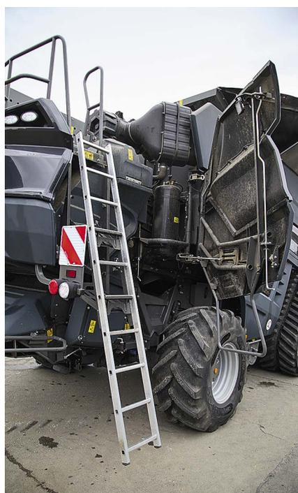
Dal retro si ha facile accesso al motore e al serbatoio del diesel da 1.250 l (disponibile in opzione anche con di 1500 l).
