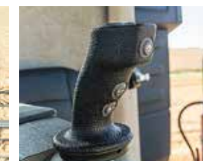
Sur le joystick se trouvent les boutons actionnant les clignotants, les feux, le guidage automatique et le klaxon.
