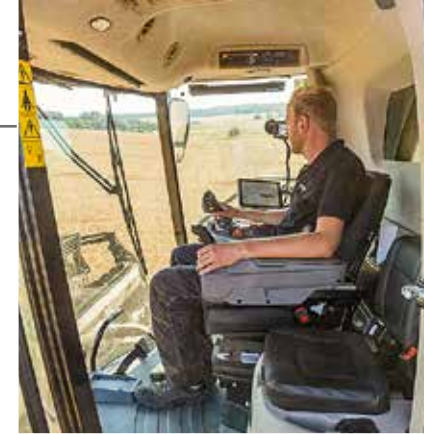
Conduire sans être dérangé par le volant : avec l'Idealdrive, il n'y a plus de volant mais seulement un joystick à la main gauche.
