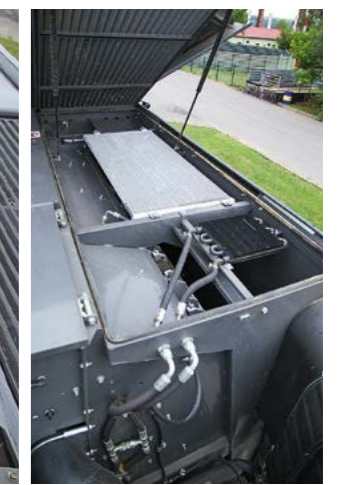
Der MAN hat bis zu 647 PS, der Kühler saugt nur von oben an und muss dank Umkehrlüfter so gut wie nie ausgeblasen werden.
