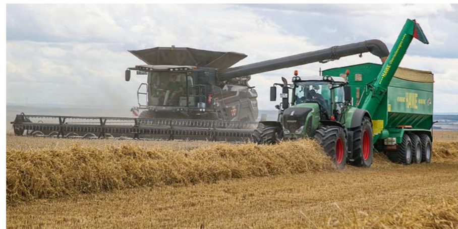
Die Überladehöhe ist mit 4,40 m knapp, die Überladeweite passt nicht zu 10,70 m Schnittbreite. Der 17 Kubik Bunker mit nur 80 Sekunden Entladedauer ist dagegen ein Maßstab.
