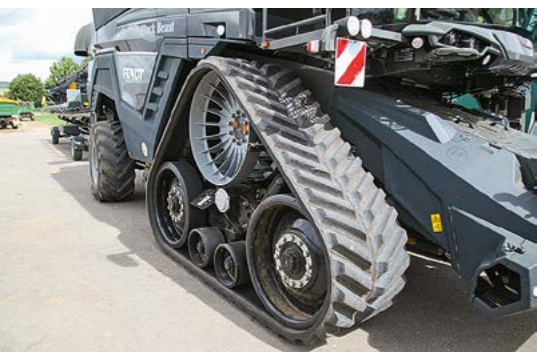
Die Raupenlaufwerke sind 2 m hoch und fast 2 m lang. Bei 76,50 cm Bandbreite bleibt die Maschine unter 3,50 m. Zudem sind 40 km/h drin, auf steilen Straßen fehlte dann aber die Durchzugskraft.
