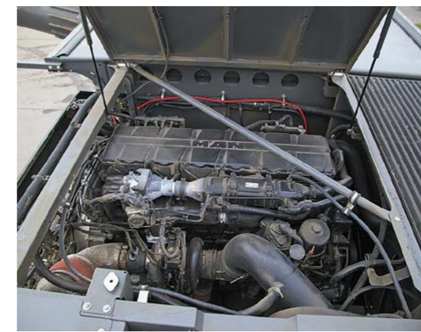
Der MAN hat bis zu 647 PS, der Kühler saugt nur von oben an und muss dank Umkehrlüfter so gut wie nie ausgeblasen werden.
