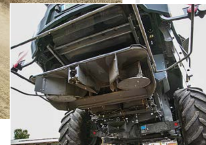
Die gleichmäßige Häckselstrohverteilung war nach dem letzten Umbau auf das ActiveSpread SwingFlow in Ordnung.
