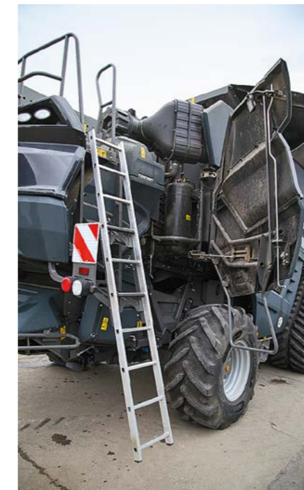
Von hinten geht es bequem zum Motor und dem 1250 l großen Dieseltank, der optional sogar mit 1500 l zu haben ist.
