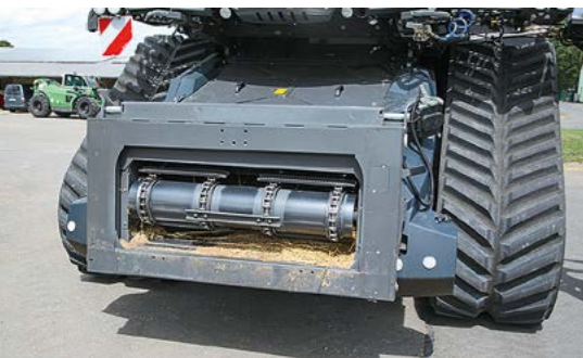
Der Kanal ist nur 1,40 m breit, hat aber vier Ketten und schafft richtig Material weg. Die automatische Schneidwerkstopplung hatte die Testmaschine leider nicht.
