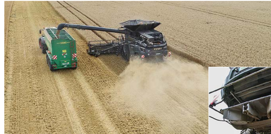
Die gleichmäßige Häckselstrohverteilung war nach dem letzten Umbau auf das ActiveSpread SwingFlow in Ordnung.
