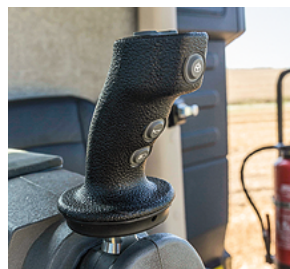
Auf dem Joystick finden sich Taster für die Blinker, an der Vorderseite für Licht, die Spurführung und die Hupe.
