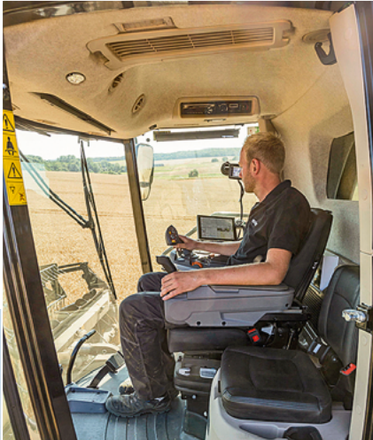
Steuern ohne störendes Steuerrad: Beim Idealdrive gibt es kein Lenkrad mehr, sondern noch einen Joystick für die linke Hand.
