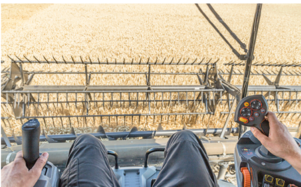
Auf dem Joystick finden sich Taster für die Blinker, an der Vorderseite für Licht, die Spurführung und die Hupe.
