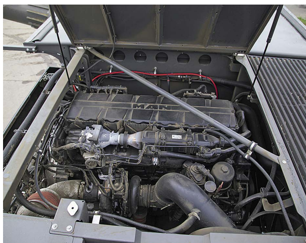
MAN har op til 647 hk, køleren suger kun oppefra og grundet returblæseren skal den så godt som aldrig udblæses.
