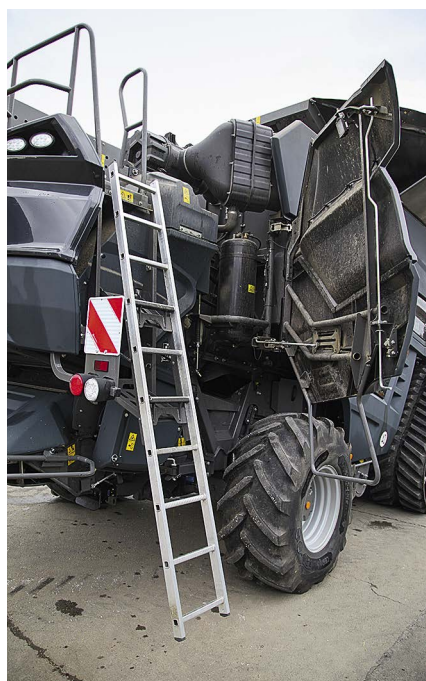
Bagfra er der god adgang til motoren og den 1.250 l store dieseltank, der endda fås med en kapacitet på 1.500 l.
