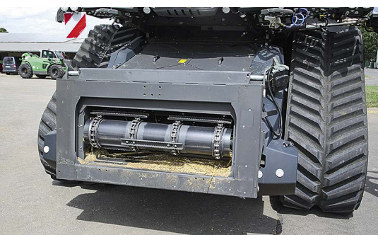
Kanalen er kun 1,40 m bred, men har fire kæder og stor kapacitet. Testmaskinen var desværre ikke udstyret med den automatiske skærebordsmontering.
