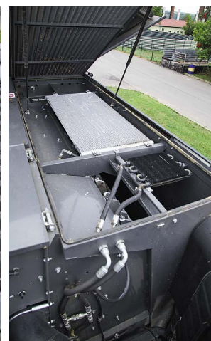
MAN har op til 647 hk, køleren suger kun oppefra og grundet returblæseren skal den så godt som aldrig udblæses.
