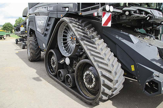
Bæltedrevene er 2 m høje og næsten 2 m lange. Ved en båndbredde på 76,50 cm er maskinen på under 3,50 m. Desuden når den op på 40 km/t, men på stejle veje mangler den gennemslagskraft.
