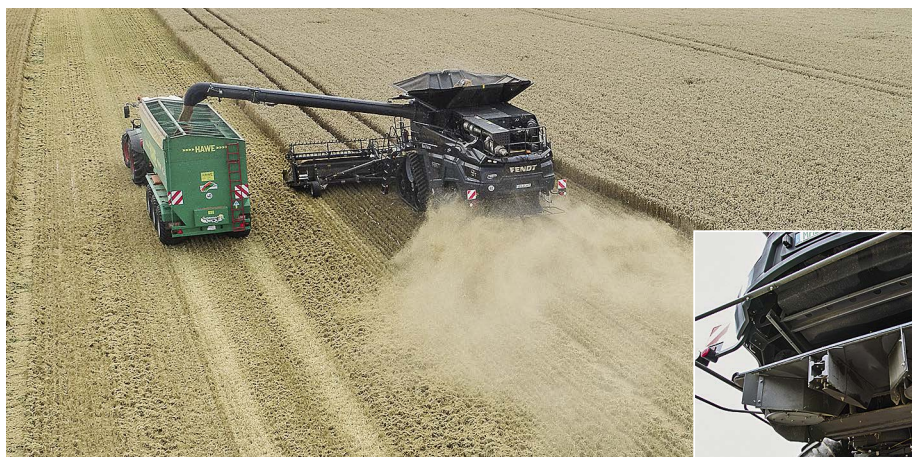
Den jævne fordeling af den snittede halm var efter sidste ombygning på ActiveSpread SwingFlow i orden.
