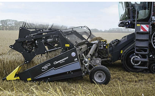
Det 10,70 m brede Geringhoff TruFlex-skærebords ydelse er i top. En sammenligning med PowerFlow følger i næste udgave.
