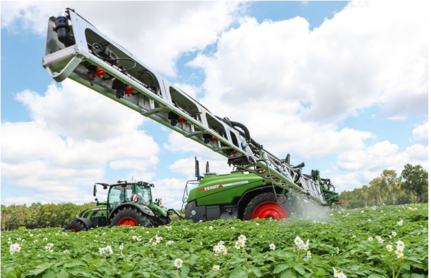
Wertvolle Betriebsmittel nie doppelt einsetzen: Die automatische Teilbreitenschaltung ist ein Muss für alle, die möglichst effizient arbeiten wollen.
