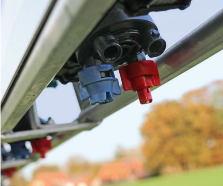
In Kombination mit Fendt OptiNozzle arbeiten Spritze und Traktor effizient zusammen. Die Pflanzenschutzspritze errechnet die optimale Geschwindigkeit passend zu den Düsenparametern, der angestrebten Abdriftreduktion und Ausbringung.
