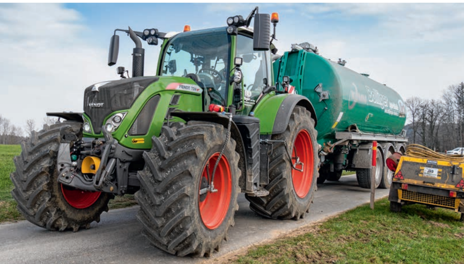
Mit dem Fendt 724 Vario und dem 26-Kubik-Zubringerfass wird die Gülle an die Feldränder transportiert.
