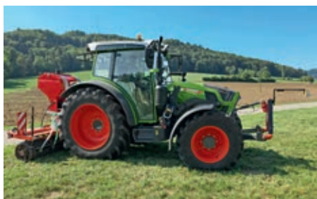
Der Fendt Traktor ist mit einer Kamera ausgestattet, der die kahlen Stellen im Bestand identifiziert.
