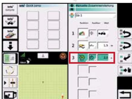
10 Als letzter Schritt folgt die Funktion **Tempomat aktivieren**. Diese wird 2 Sekunden nach der Aktivierung des Hydraulikventils ausgeführt. Stellen Sie die Funktion, den Auslöser und den Wert ebenfalls über Antippen der entsprechenden Felder ein.
