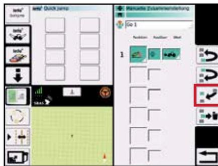
8 Im ersten Schritt soll die **Funktion Heckkraftheber absenken** ausgeführt werden. Diese wird automatisch über die Taste am Fahrhebel (Auslöser) bei Vorwärtsbewegung (Wert) ausgelöst. Drücken Sie nun erneut die **Taste Neuer Schritt hinzufügen**, um die Sequenz zu erweitern.
