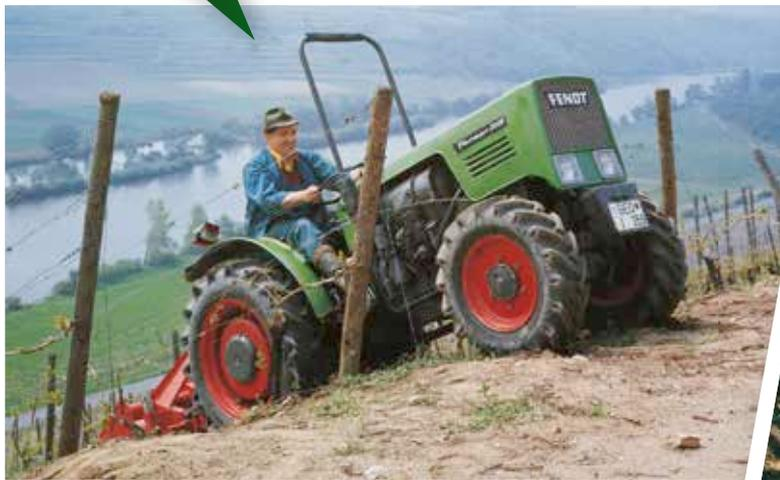
▲ Der Fendt Farmer 200 V erreichte mit seinem Schnellgang 25 km/h und wurde speziell für Sonderkulturbetriebe entwickelt.
