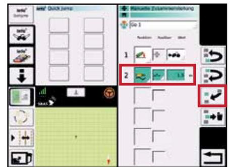
9 Die **Funktion Hydraulikventil aktivieren** wählen Sie über ein Pop-up Fenster durch Antippen des Feldes **Funktion** in der 2. Zeile. Hier soll das Hydraulikventil in Abhängigkeit von der gefahrenen Strecke aktiviert werden. Tippen Sie dann das Fenster **Wert** an. Die gewünschte Wegstrecke stellen Sie über das Drehrad an der Seite des Terminals ein. Drücken Sie nun erneut die **Taste Neuer Schritt hinzufügen**.
