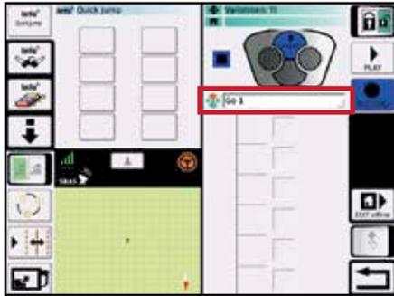
4 Hier können Sie bis zu vier unterschiedliche Sequenzen abspeichern. Diese können Sie dann mit den entsprechenden Tasten auf dem Fahrhebel auslösen. In diesem Beispiel konfigurieren wir die **Sequenz für den Feldanfang** (hier auf **Taste Go 1**).
