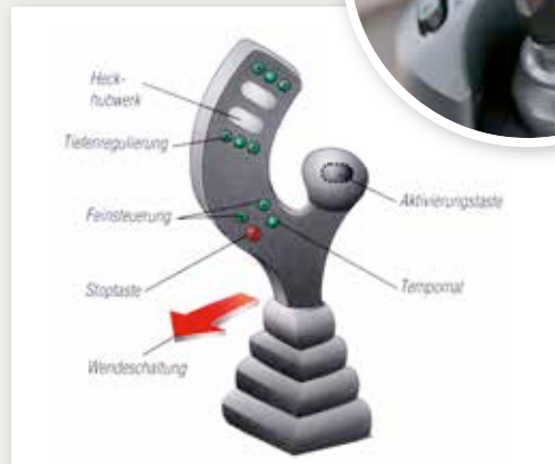
► Der Joystick der ersten Generation vereinfachte die Traktorbedienung deutlich.
