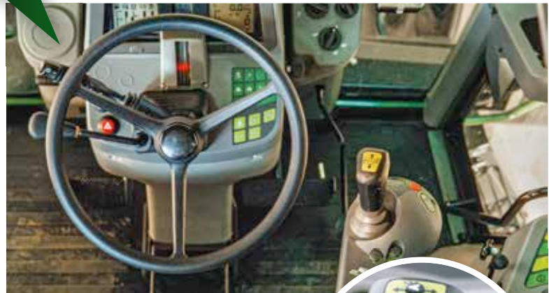
► Der Joystick der ersten Generation vereinfachte die Traktorbedienung deutlich.
