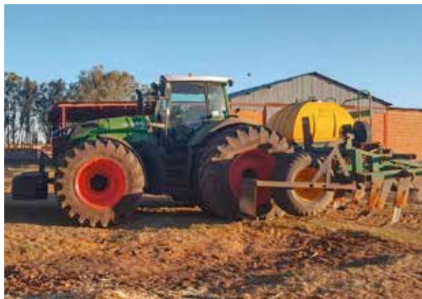
▲ Am Fendt 1050 Vario ist ein 7 t schwerer Tiefenlockerer, mit dem bis zu einer Tiefe von 80 cm gearbeitet wird. Gleichzeitig wird Mineraldünger eingearbeitet.
