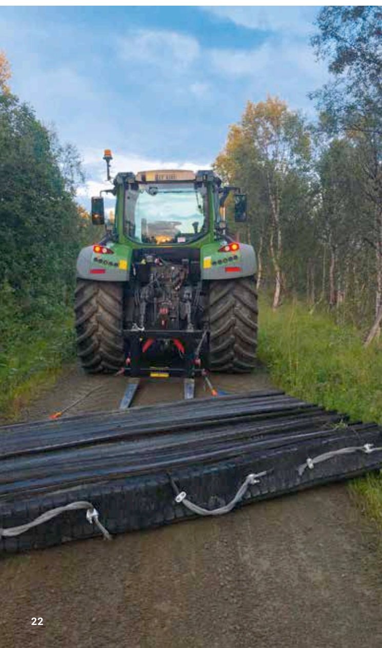
▼ Mit seinem Fendt 516 Vario kann er so den Schotter wieder gleichmäßig verteilen.
