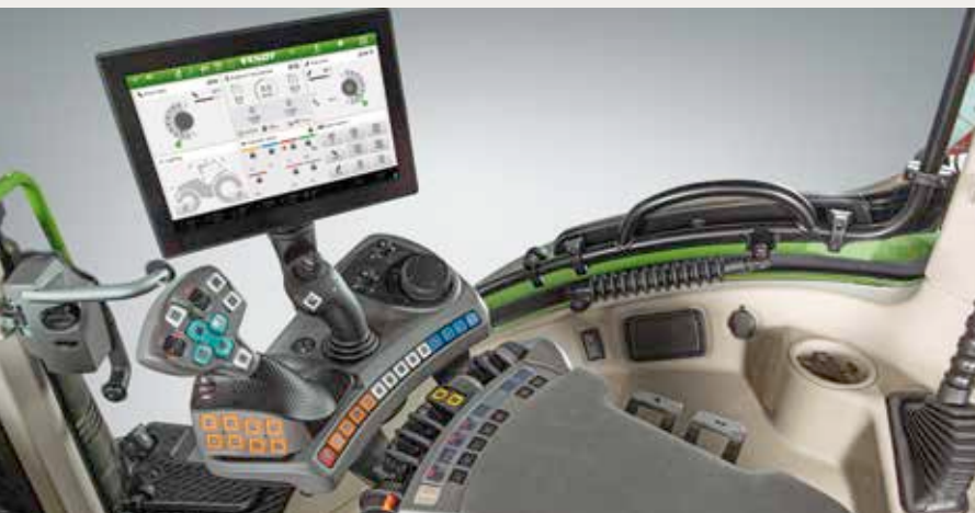
▲ Der neue Fendt Fahrerarbeitsplatz mit Multifunktions-Fahrhebel, 3L Joystick und Dreh-Drücksteller
