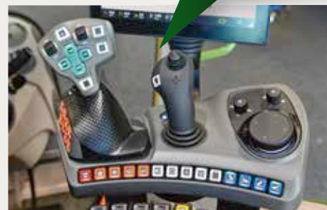
▲ Der neue Fendt Fahrerarbeitsplatz mit Multifunktions-Fahrhebel, 3L Joystick und Dreh-Drücksteller
