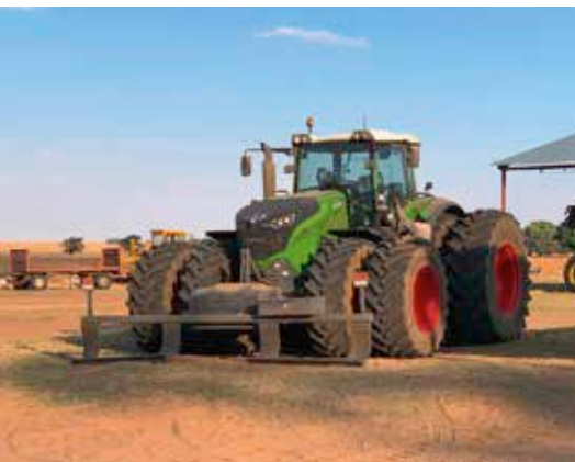
▲ Der Frontanbau soll die Maisstoppeln in Fahrtrichtung knicken, um die Reifen zu schonen, da der Traktor überwiegend im Mais fährt.
