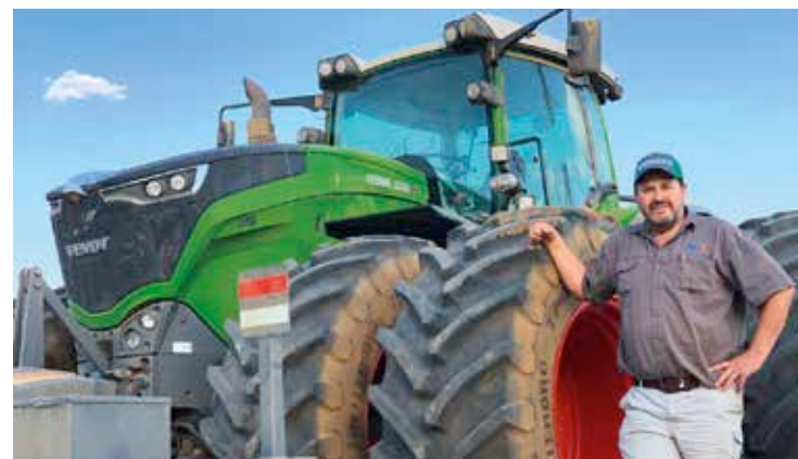
▲ Fanie vor seinem 1050. Die Abstände der Front-Zwillingsreifen sind größer, damit sich die Steine nicht zwischen den Reifen verklemmen. Auf der Farm wird mit sehr niedrigem Luftdruck gefahren. Bodenschonung!
