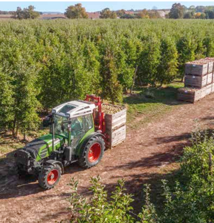
▲ Vorteil des Pendelkrafthebers: genaues Ausrichten der Arbeitsgeräte und präzise Steuerung des Heckhubstaplers.
