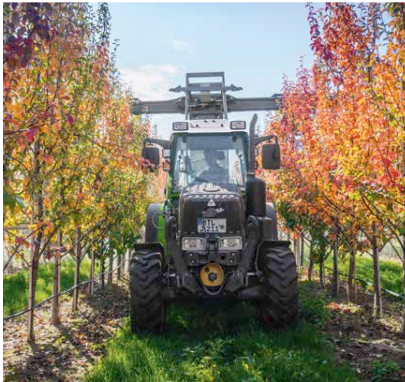
▲ Pflanzenschutz: Der Einsatz mehrreihiger Verfahren ist wichtig, damit ein Fahrer eine größere Flächenleistungen schafft.
