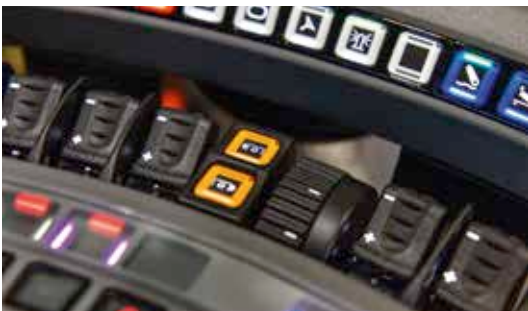
▲ Über den IOM (Individual Operation Manager) können zahlreiche Tasten frei mit Funktionen belegt werden.
