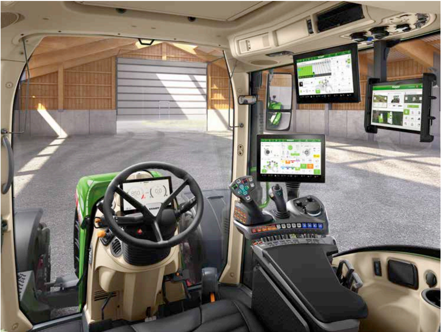
▲ Der neue 700er Arbeitsplatz: hier mit dem neuen Multifunktions-Joystick und 3L Joystick sowie drei Terminals.
