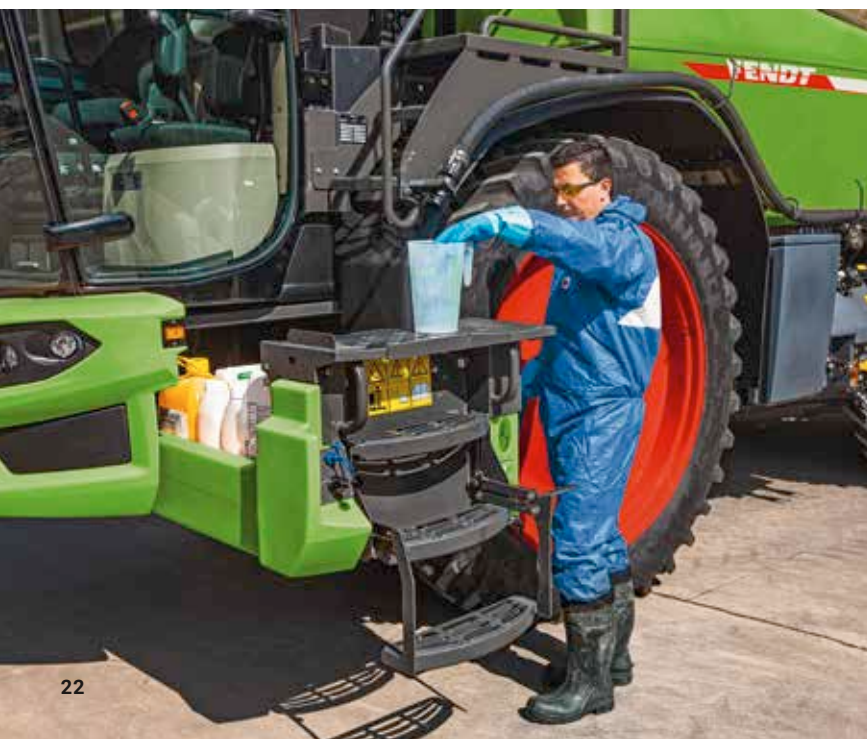
◀ Das Befüllen der Maschine mit flüssigen Pflanzenschutzmitteln geht beim Rogator sehr komfortabel. Die 60 l fassende Einspülschleuse hat einen Durchsatz von bis zu 200 l/min.
