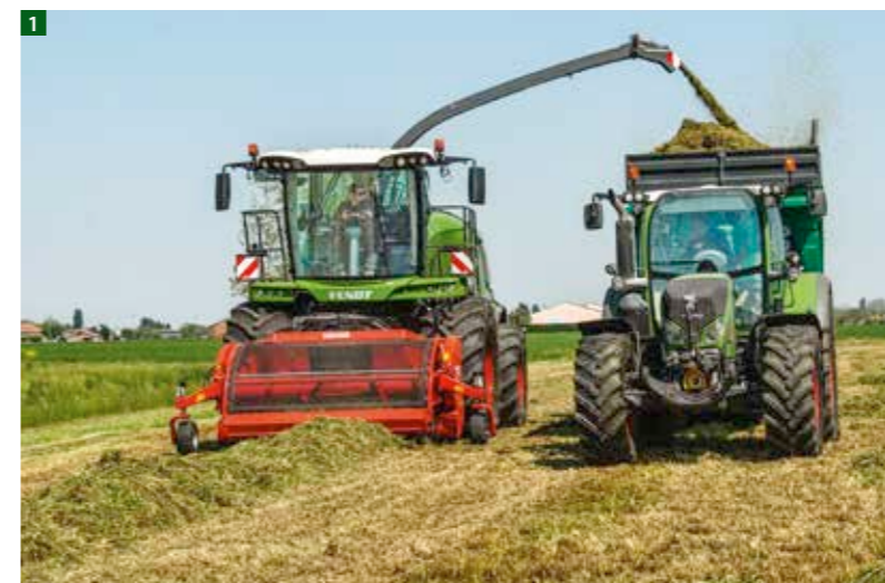
1 Der Fendt Katana 85 mit der Gras Pickup P3002 von Kemper und mit neuem HD-Antrieb erreicht auch unter extremen Erntebedingungen einen hohen Durchsatz. Die mittig integrierte Tastrolle sorgt für eine noch bessere Boden Anpassung. Durch den stufenlosen Vorsatzantrieb kann die Geschwindigkeit der Pickup präzise an die Erntebedingungen und die Vorfahrtsgeschwindigkeit des Feldhäckslers angepasst werden.
