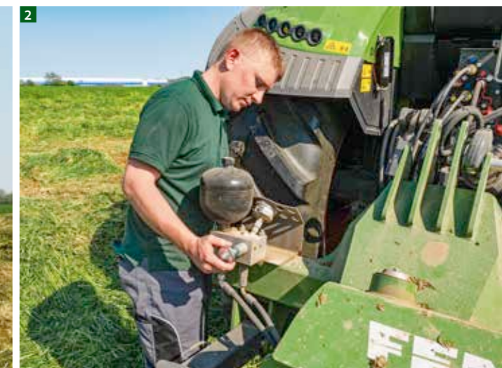
2 Fendt Grünlandexperte Johannes Grötsch stellt über das hydropneumatische TurboLift System den Auflagedruck des Scheibenmähwerts Fendt Slicer 3670 TLXKC ein. Durch den schwebenden Schnitt wird die Grasnarbe geschont und eine optimale Futterqualität erzeugt. Gerade in feuchten und nassen Stellen bleibt das Futter stets frei von Schmutz.
