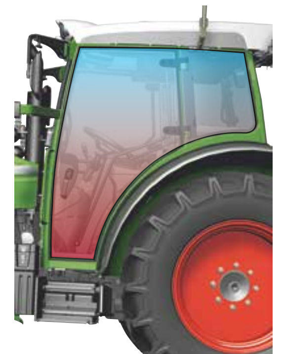
▲ Schematische Temperaturverteilung in der Kabine. Kühlere Temperatur im oberen Bereich, wärmere Temperatur im unteren Bereich.
