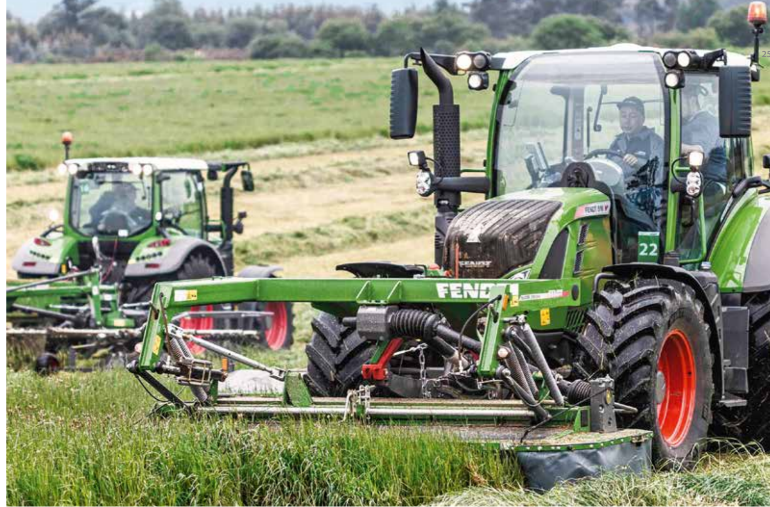
(o.) Fendt 516 Vario mit Scheibenmähwerk Fendt Slicer 310 FZKC in Front
