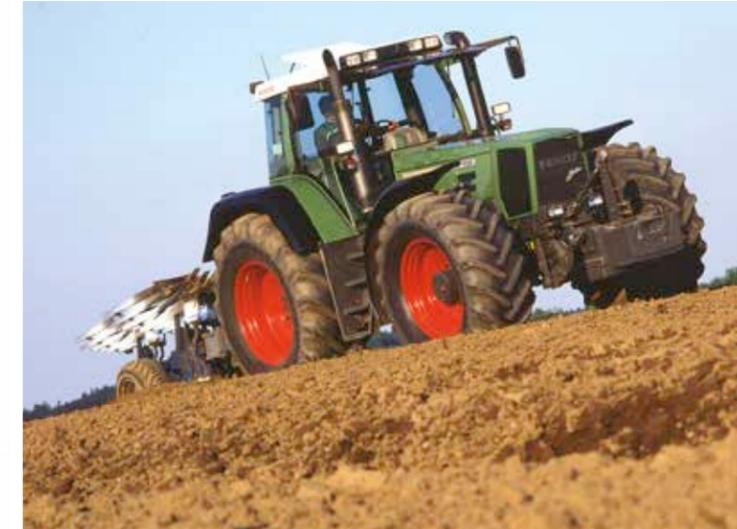
Er war der erste Traktor weltweit mit stufenlosem, variablem Fahrtrieb: der Fendt Favorit 926 Vario aus dem Jahr 1995. Die Erfindung revolutionierte die Landtechnik.
