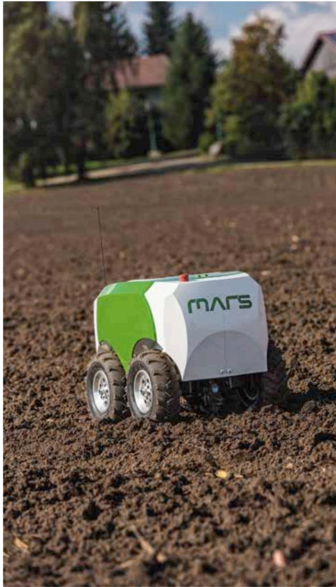
MARS Roboter können z. B. im Frühjahr früher rausfahren zum Säen, wenn große Maschinen noch einsinken.
