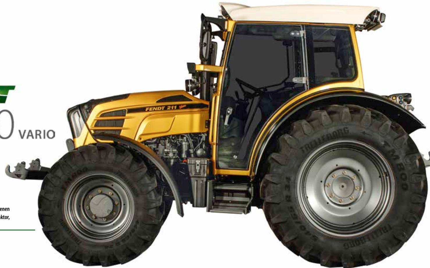
Das 100.000ste Variogetriebe ist das Herzstück dieses goldenen Fendt 211 Vario, gebaut 2009. Seither fährt jeder Fendt Traktor, vom größten bis zum kleinsten, stufenlos.
