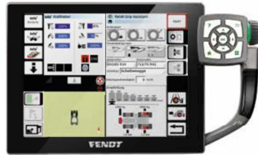
Damit die Motorleistung bestmöglich und schonend in Vortrieb umgesetzt werden kann – egal bei welcher Arbeit oder unter welchen Bedingungen – hilft der Fendt Grip Assistant schnell und einfach den besten Ballast, die passende Geschwindigkeit oder den optimalen Reifendruck zu finden.
