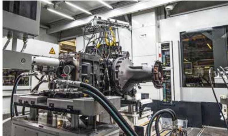
Es ist ein Test auf Herz und Nieren: ein Variogetriebe in der geschlossenen Prüfkabine.
