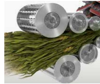
Größtmögliche Verdichtung des Schnittguts dank 6 Vorpresswalzen, vorgespannt mit groß dimensionierten Federpaketen
