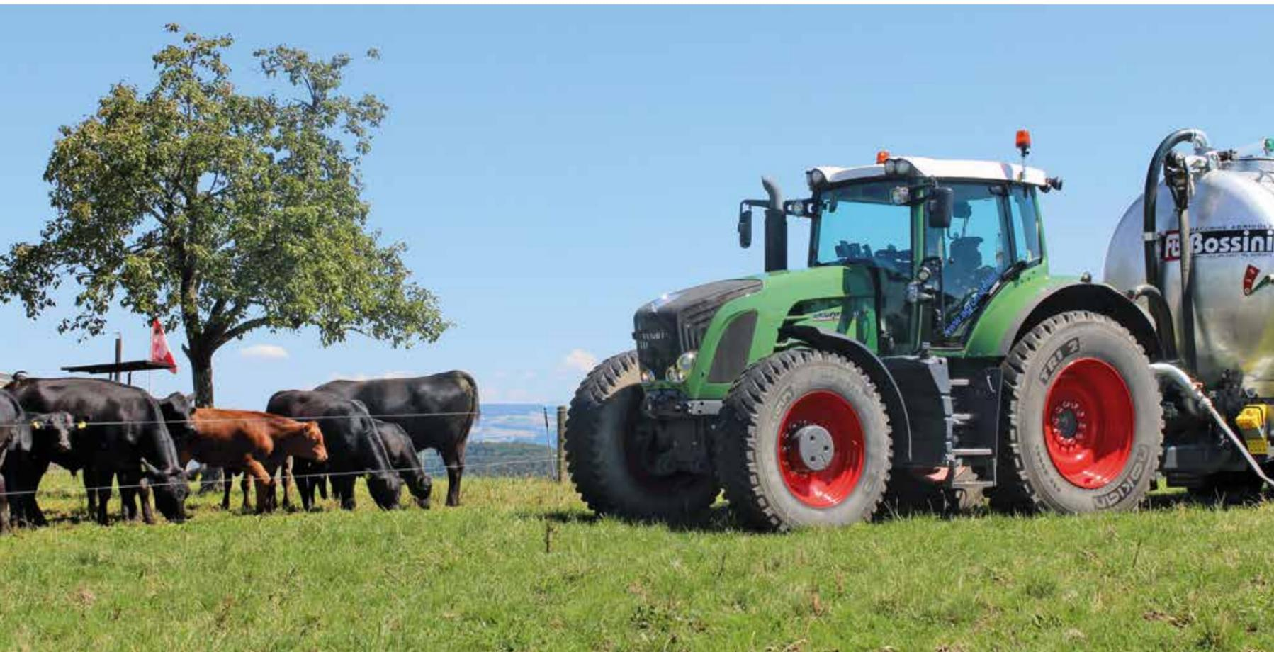
Da die Güllegespanne der Firma Agromesser fast nur auf der Straße unterwegs sind, ist die Bereifung dementsprechend: Bei den Traktoren sind es spezielle Straßenreifen und bei den Güllefässern LKW-Reifen.
