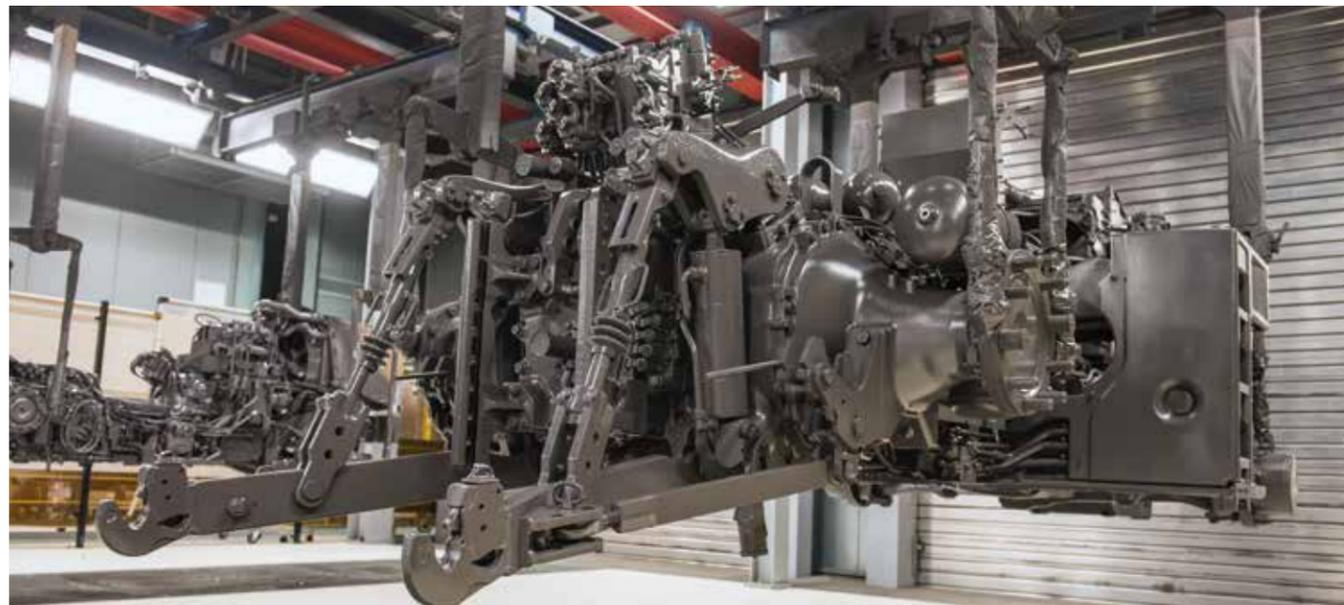
Korrosionsschutz: In den HighTech-Lackierkabinen sorgen spezielle Roboter für einen gleichmäßigen Auftrag der durchschnittlich 250 bis 300 µm dicken Lackschicht auf jedem Traktorrumpf. Zum Vergleich: Das ist ein Mehrfaches gegenüber dem Standard in der Automobilindustrie.
