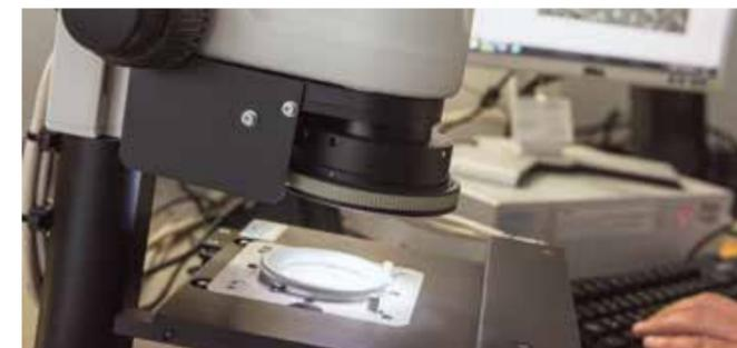
Partikelanalyse gegen Abnutzungs- und Folgeschäden.
