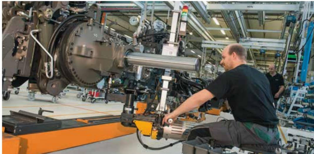
Für höchste Qualität und maximale Sicherheit: Die Schrauben werden mit einem definierten Drehmoment angezogen. Der Mitarbeiter bekommt durch ein Ampelsystem signalisiert, wann die Bauteile „richtig sitzen“.
