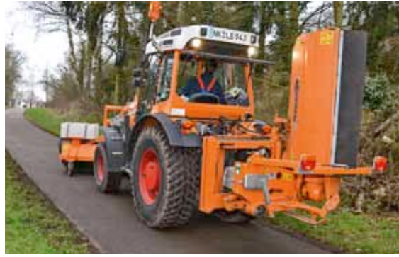
Mit dem Fendt 209 F Vario werden Geh- und Radwege instand gehalten.
