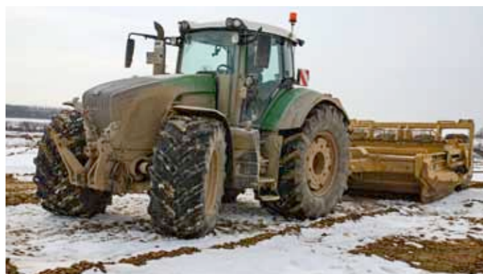
Mit dem Schürfkübel wird Erde abgetragen, um an die darunterliegende Sandschicht zu gelangen.
