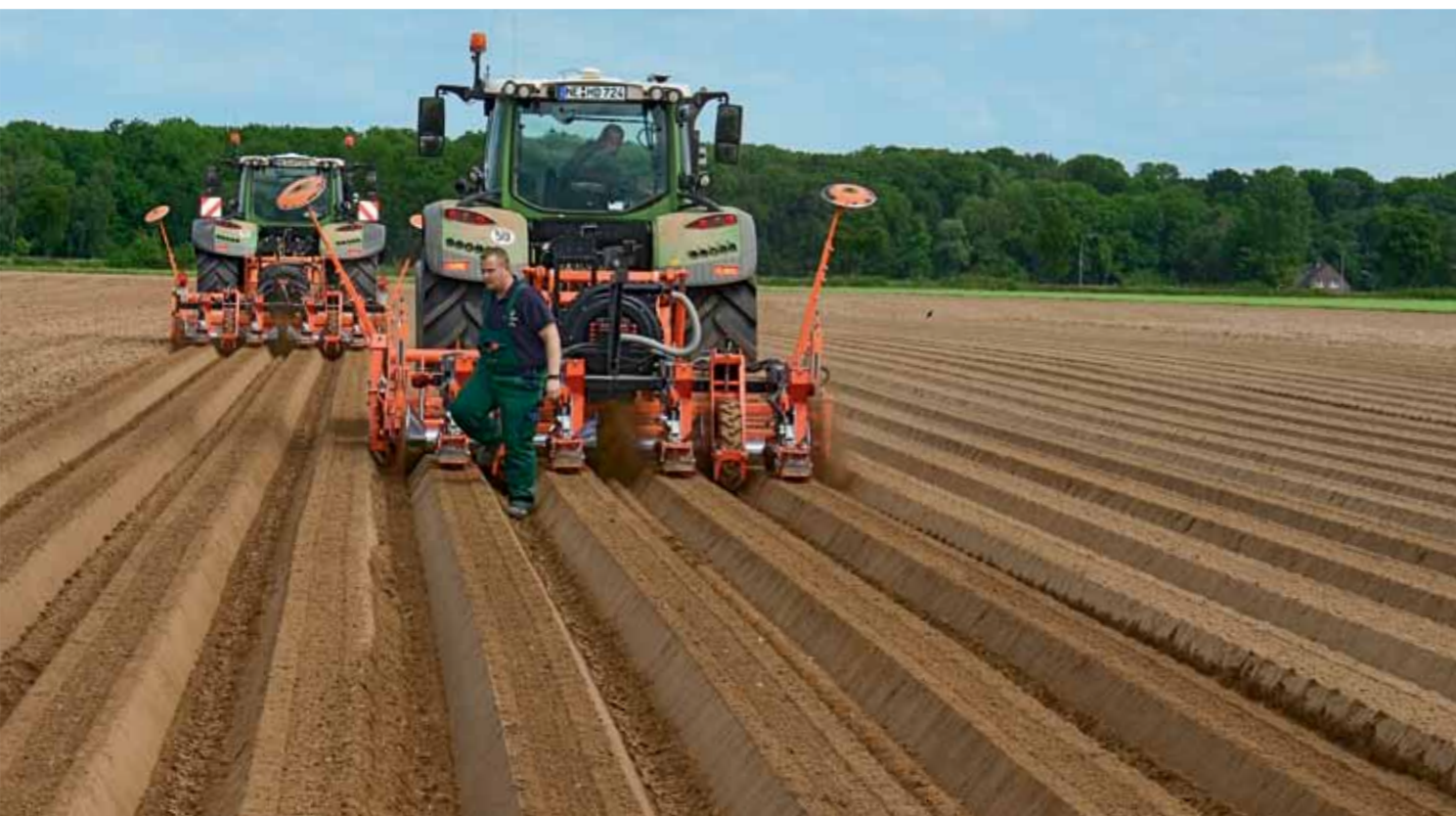
Die beiden Maschinenkombinationen ziehen mit VarioGuide RTK präzise jeweils vier Dämme mit Möhrensamen.
