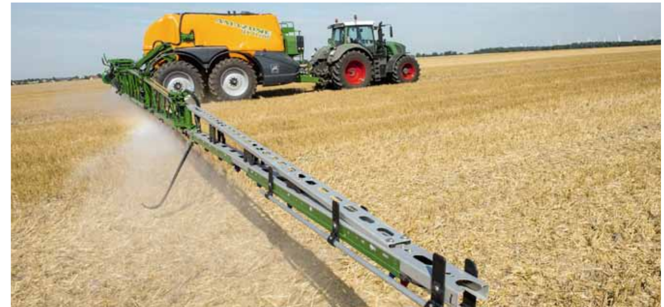
VariableRateControl (VRC) bietet die Möglichkeit, bis zu 5 Applikationskarten parallel abzuarbeiten, z. B. beim Spritzen.
