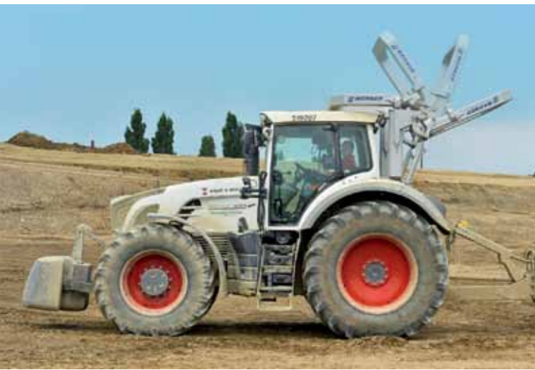
Der Fendt 900 Vario ist mit einem Überrollbügel ausgestattet. Denn Sicherheit ist auf einer Großbaustelle oberstes Gebot.
