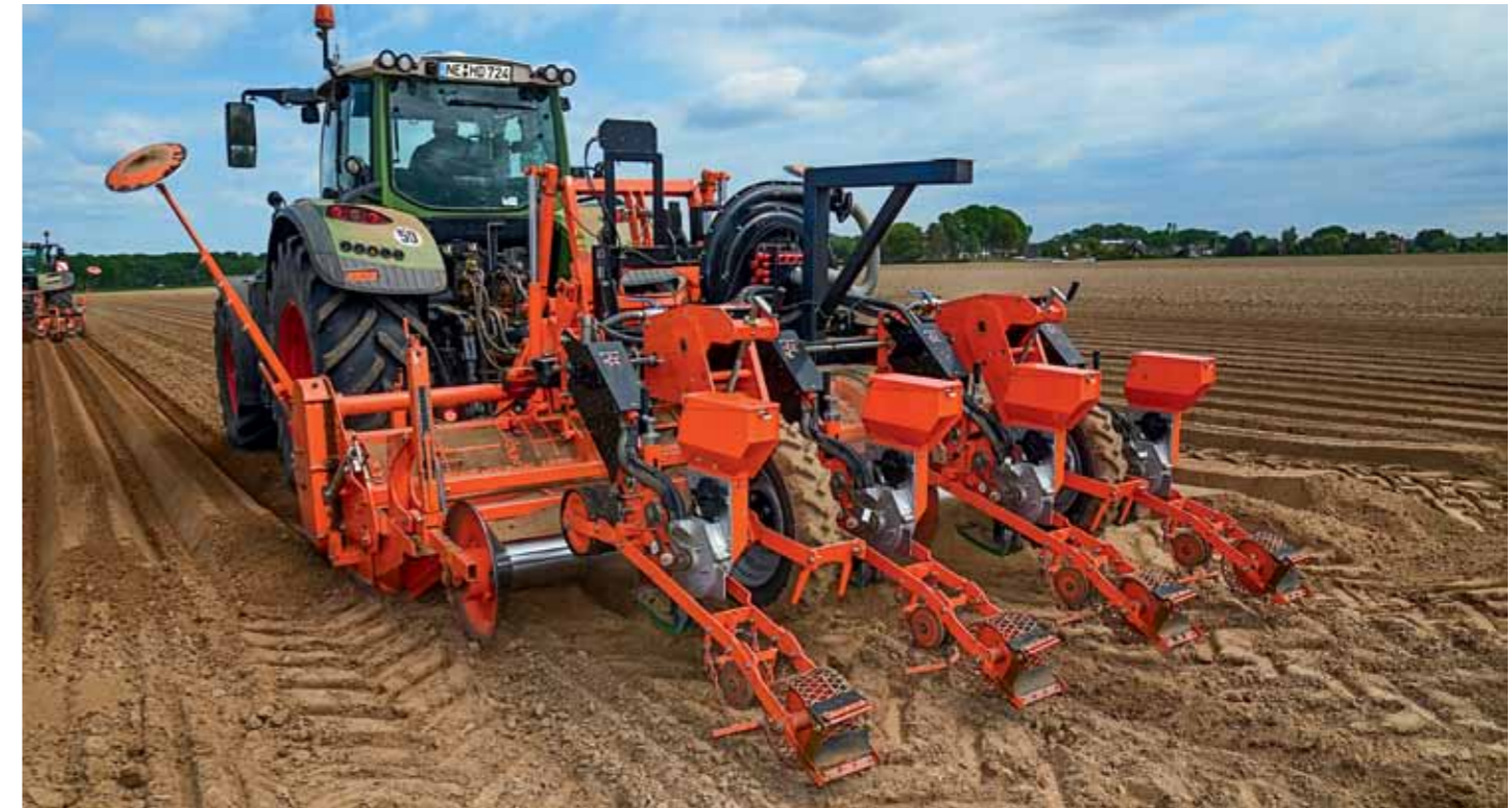
Möhrensaat der Leyen-Nesselrode GbR bei Grevenbroich mit VarioGuide RTK und VarioDoc Pro.
