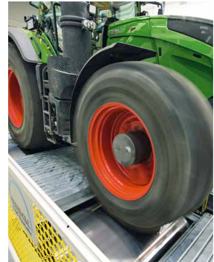
Der flexibel anpassbare Achsenabstand von 2–6 m sorgt dafür, dass vom 200 Vario bis zum 1000 Vario alle Traktoren getestet werden können, und zukünftig noch viel mehr.
