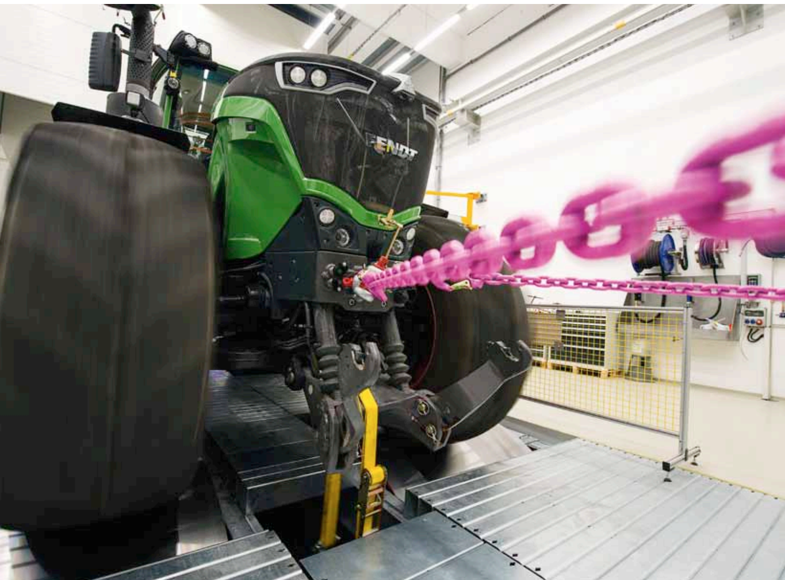
Die genormten pinkfarbenen Ketten halten Kräfte bis zu 20 Tonnen.
