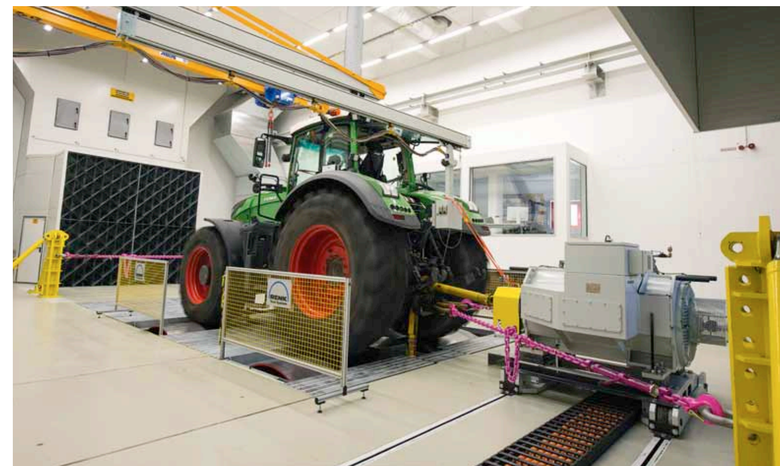
Im Hintergrund: Mithilfe der Zuluft-Düse in Wabenform wird Luft mit bis zu 20 km/h laminar (ohne Turbulenzen) durch den Prüfraum geblasen.
