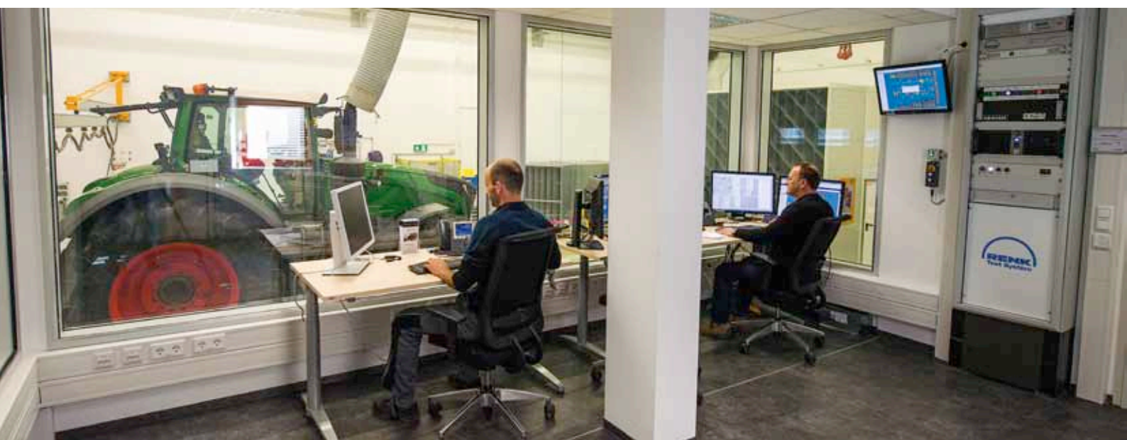
Im Hintergrund: Mithilfe der Zuluft-Düse in Wabenform wird Luft mit bis zu 20 km/h laminar (ohne Turbulenzen) durch den Prüfraum geblasen.
