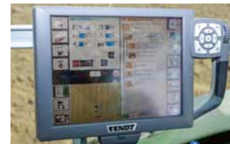
Fendt Terminal, VarioDoc, Hauptseite: Im unteren linken Viertel auf dem Terminal sind das zu bearbeitende Feld und die Spuren deutlich zu erkennen. Auf der rechten Seite im Hauptmenü werden Maschine, Fahrer, Feld, Kulturart und die Tätigkeit dokumentiert. Nach Abschluss der Arbeit werden die Daten an den Bürocomputer gesendet.
