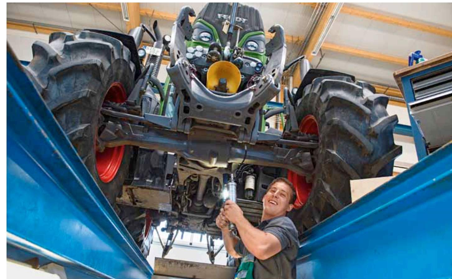
Die Werkstattgrube ist für eine Achslast von bis zu 20 Tonnen ausgelegt.
