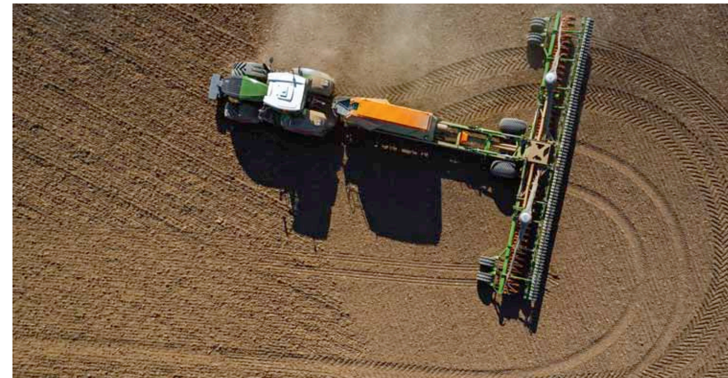
„pull-in-turn“-Effekt: Durch den variablen Allrad zieht das Vorderrad den Traktor in die Kurve und reduziert den Wendekreis zusätzlich um zehn Prozent bzw. 1 Meter.
