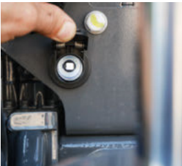
■ 12 V savienojums mašīnas aizmugurē apgādā ar strāvu ārējos patērētājus.
