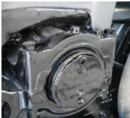
□ Kāpurķēdes platuma regulēšanas sistēma padara Fendt 900 Vario MT par ideāli izmantojamu ar rindās audzējamiem kultūraugiem.
