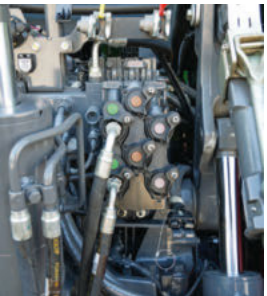
Hidrauliskā sistēma ir paredzēta maksimālai darbībai, un tā piedāvā opciju līdz 440 l/min. darbības pie 1700 apgr./min.
