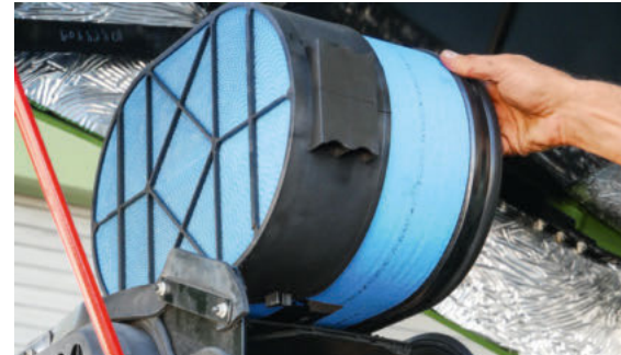
Gaisa filtrs ir viegli nomaināms un tam ir netīrumu sensors, kas sniedz informāciju par filtrēšanas rezultātiem.
