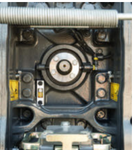
Var izvēlēties vienu no jūgvārpstas griešanās ātrumiem: 1000 un 1000E.
