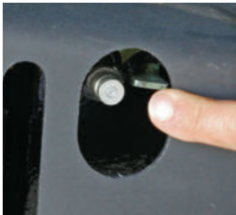
□ Kāpurķēžu lentes iepriekšējās nospiegošanas spiedienu var ērti regulēt no sāniem ar savienojuma palīdzību.
