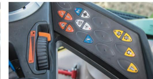
Getriebe-, Hydraulik- und Zapfwelleneinstellungen nehmen Sie an den Folientastern in der Armlehne vor.
