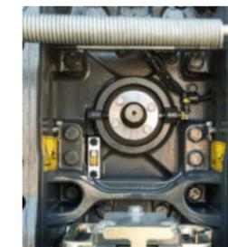
Wählen Sie zwischen zwei Zapfwellengeschwindigkeiten: 1000 und 1000E.
