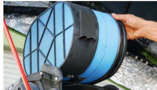
Der Luftfilter ist leicht zu tauschen und besitzt einen Schmutzsensoren, der über die Filterwirkung Auskunft gibt.
