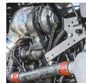
Zwei Turbolader mit fester Geometrie und elektronischer Wastegate-Steuerung bieten enormes Drehmoment über den gesamten Drehzahlbereich.
