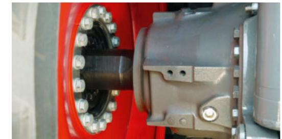
Die robuste Hinterachse ist für längste Lebensdauer gebaut. Der eigene Ölhaushalt kann bequem über Schaugläser kontrolliert werden.
