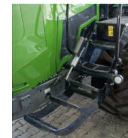
Der Aufstieg zur geräumigen Kabine gelingt über eine automatisch hoch- und runterklappende Leiter.
