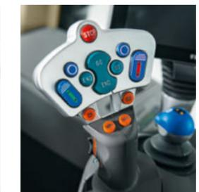
Der optionale Profi-Joystick verfügt zusätzlich noch über Tasten zur Bedienung zweier Hydraulikventile.
