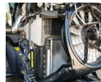
Für perfekt temperierte Ansaugluft sorgt ein großer Ladeluftkühler mit einem Wärmetauscher als Zwischenladeluftkühler.
