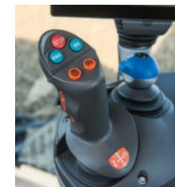
Mit dem serienmäßigen Power-Multifunktionsjoystick steuern Sie die Geschwindigkeit, den Tempomaten und Drehzahl-speicher und das Vorgewende-management.
