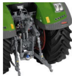
Trepunktshydraulikk bak med fanghaker og sidestabilisatorstag (EU)
