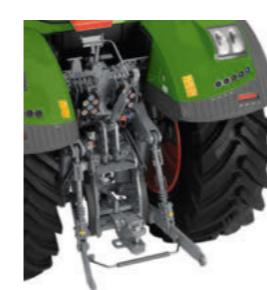
Trepunktshydraulikk bak med kuleender og stabilisatorblokker
