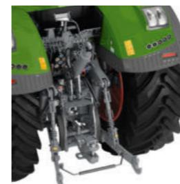
Trepunktshydraulikk bak med fanghaker og stabilisatorblokker (unntatt EU)
