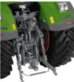
Galinis keltuvas su greito užkabinimo kabliu ir trinties bloku (AU)
