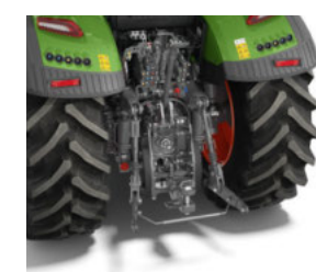
Baklyft med kulor och Rub Blocks
