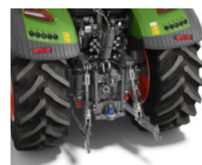
Bakre trepunktslyft med snabbkopplingskrokar och sidostöd (EU)
