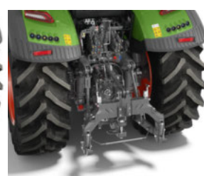
Quick Hitch-ram med hydraulisk öppning av fångkrokarna som standard
