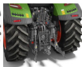
Baklyft med snabbkopplingskrokar och Rub Blocks (AU, Sydafrika, Östeuropa)
