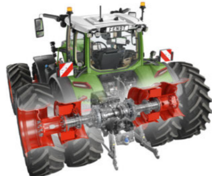
Bakaksel med justerbar sporvidde 3000 mm tvillinghjul med Duo hjulnav
