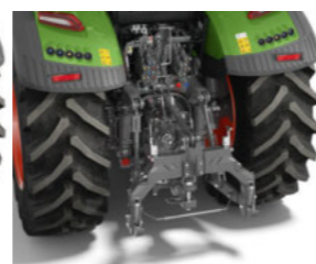
Quick Hitch-frame met standaard hydraulische opening van de vanghaken
