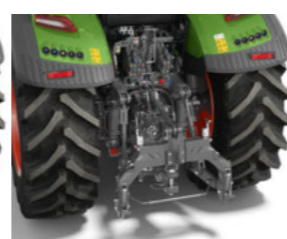
Quick Hitch keret a fogóhorgok hidraulikus nyitásával, alapfelszereltségként
