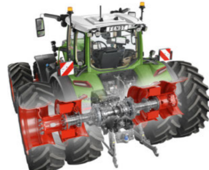
Hosszú hátsó féltengely, 3000 mm, ikerkerékek dupla kerékaggyal
