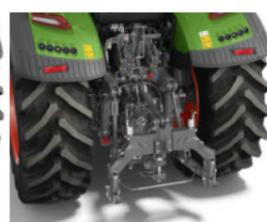
Cadre Quick Hitch avec ouverture hydraulique des crochets d'arrêt de série
