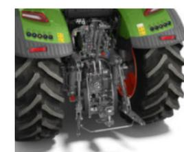
Relevage arrière à rotules et cales de débattement
