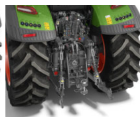
Tagumine ripphaakeseadis kiirühenduskonsude ja Rub Block ühendusplokkidega (AU, Lõuna-Aafrika, Ida-Euroopa)
