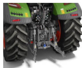
Tagumine ripphaakeseadis koos kiirühenduskonsude ja külgtõega (EL)
