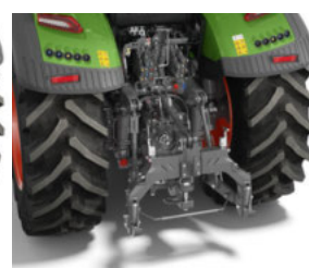
Quick Hitch-raam koos kinnituskonsude hüdraulilise avamisega standardvarustuses
