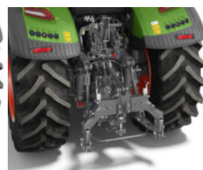
Quick Hitch-Rahmen mit serienmäßiger hydraulischer Öffnung der Fanghaken
