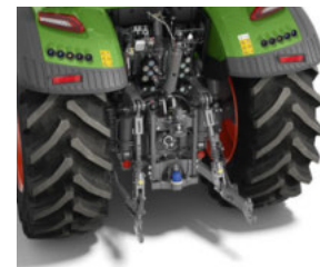
Heckkraftheber mit Schnellfanghaken und Seitenabstützung (EU)
