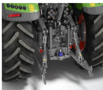
Bakre trepunktslyft med snabbkopplingskrokar och sidostöd (EU)
