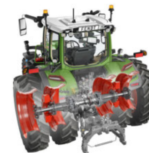
Rak bakre axel 2 500 mm Dubbeldäck med Duohjulnav
