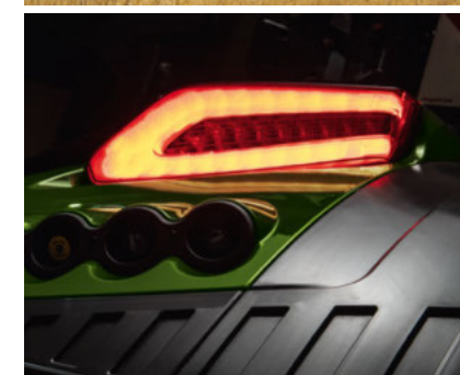
Nya LED-bakljus (CAN-kapabla) med dynamiskt ljus i blinkers
