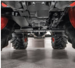
■ Bodemvrijheid maar liefst 50 cm; geen laaghangende delen zoals begrenzers of kabels
