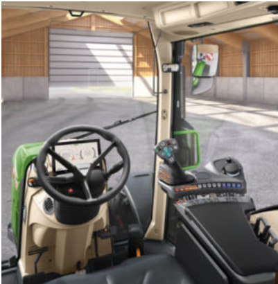
Power, Setting 1 - Zonder kruishendel - 1 lineaire module (1 paar wipschakelaars) voor het bedienen van de hydrauliekventielen
