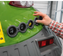
Achterhefinrichting, aftakas en één hydrauliekventiel kunnen achter op de beide achterspatborden worden bediend.
