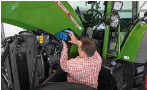
Het luchtfilter (met grote capaciteit) zorgt voor een optimale aanzuiging en reiniging van lucht en is gemakkelijk te vervangen.
