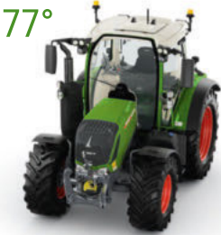
Panorama-voorruit met een gezichtshoek van 77°, voor volledig zicht naar boven en op het wielspoor.
