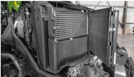
Kost minder moeite: het compacte koelerpakket is zeer goed toegankelijk en door de grote tussenruimte tussen de koelplaten en de vlakke bodem van de koeler gemakkelijk en snel te reinigen.
