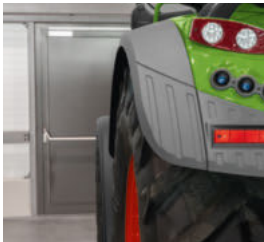
Brede spatborden dekken de gehele bovenkant van de wielen af, zowel de achter- als de zijkant, wat tot minder verontreiniging leidt.
