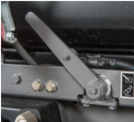
Vastzetten van de trekstangen met afsluitkraan voorkomt fout gebruik en schade aan aangekoppelde werktuigen.
