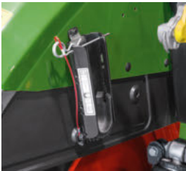
De volledig geïntegreerde kogelhouder tegen het spatbord biedt een veilige bewaarplaats.
