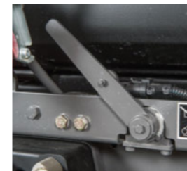
Forhindrer skader på trukne redskaber og fejlbetjening: Fiksering af liftarmene via spærrehanen.
