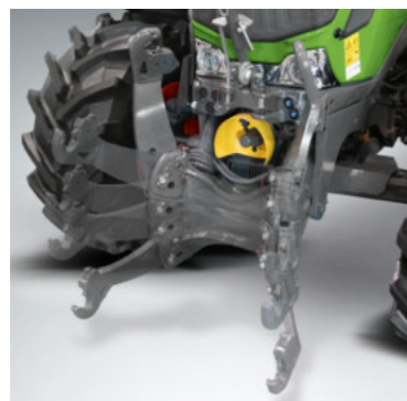
Bagerste lift, PTO og en styreventil kan betjenes på begge bagskærme.
