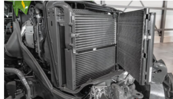
Mindre arbejde: Den kompakte kølerpakke er meget nemt tilgængelig og kan rengøres let og hurtigt, takket være de store afstande mellem kølerne og den flade kølerbund.
