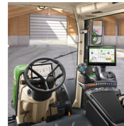
Profi Setting 2 - 3L-joystick - Et lineært modul (vippepar) til betjening af hydrauliske ventiler - 12"-terminal
