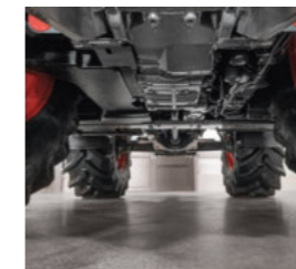
■ Op til 50 cm ægte frihøjde - uden lavtbyggede dele som anslag og ledninger.
