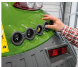
Bagerste lift, PTO og en styreventil kan betjenes på begge bagskærme.
