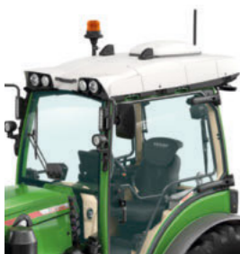
A Fendt VarioGuide vevőegység védetten és beépítve került a tetőszerkezetbe.
