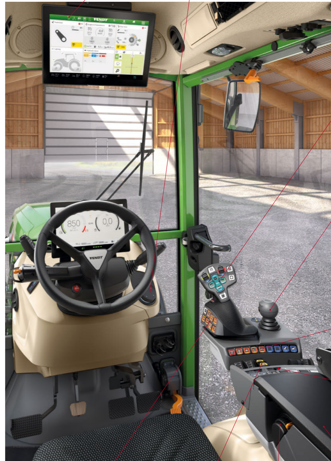
A nyomógombok segítségével könnyen működtetheti az ismerős hajtómű- és menetfunkciókat: Ide tartozik két motorfordulatszám-memória, két tempomat, valamint egy új, aktív tempomat beállító potméter.
