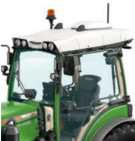
Der Fendt Guide Receiver sitzt geschützt u. integriert in der Dachkonstruktion.
