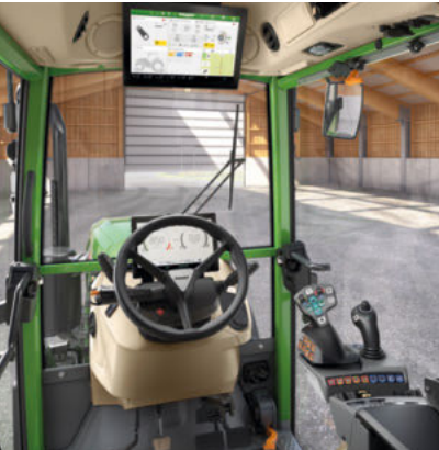
Profi+ Setting 2 - 3L-Joystick - Zwei Linearmodule (Rockerpaar) zur Bedienung Hydraulikventile - 12" Terminal
