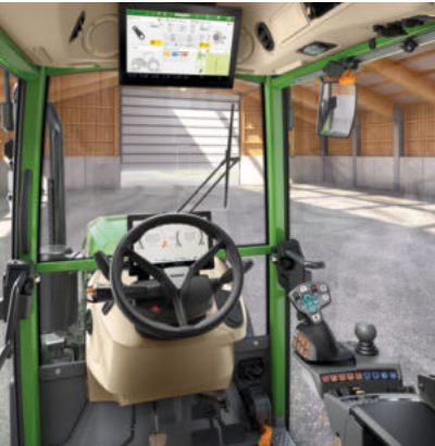
Profi+ Setting 1 - Kreuzschalthebel - Zwei Linearmodule (Rockerpaar) zur Bedienung Hydraulikventile - 12" Terminal
