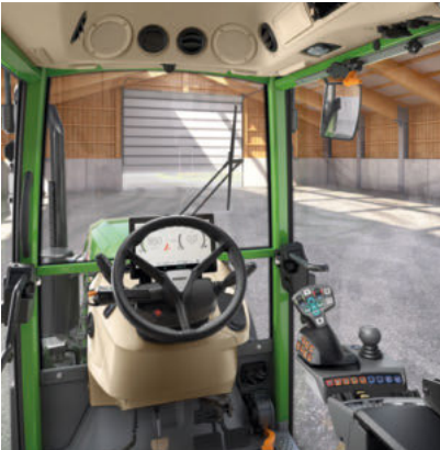
Profi Setting 1 - Kreuzschalthebel - Zwei Linearmodule (Rockerpaar) zur Bedienung Hydraulikventile
